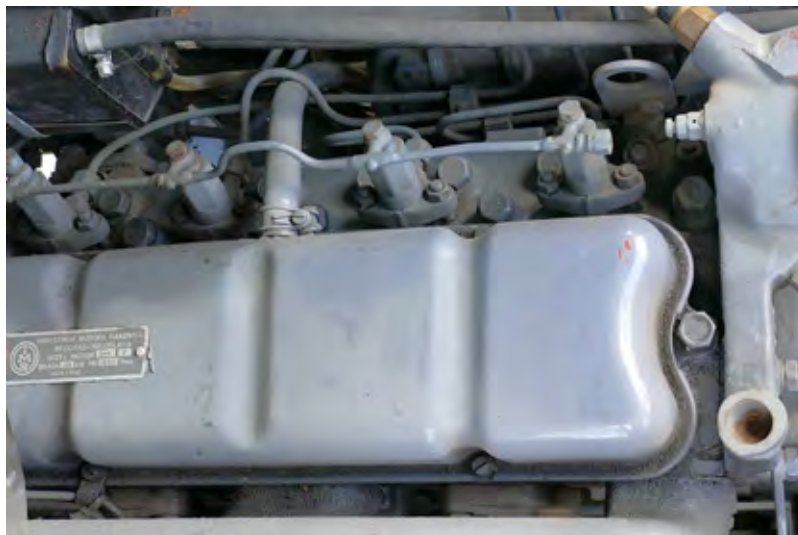
Na motorju so doslej odvili le cevke do šob, da so temeljito odzračili sistem, vsi drugi vijaki so še tovarniško pobarvani.
