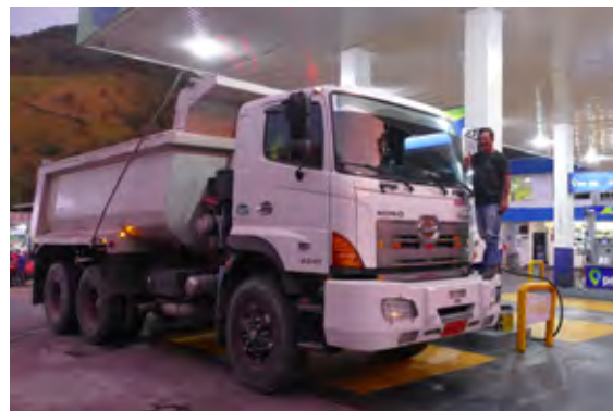
Enostrani prekucnik Hino 700 je težkokategornik; zanimivo je, da vozi po 24-palčnih pnevmatikah, montiranih na platišča trilex.
