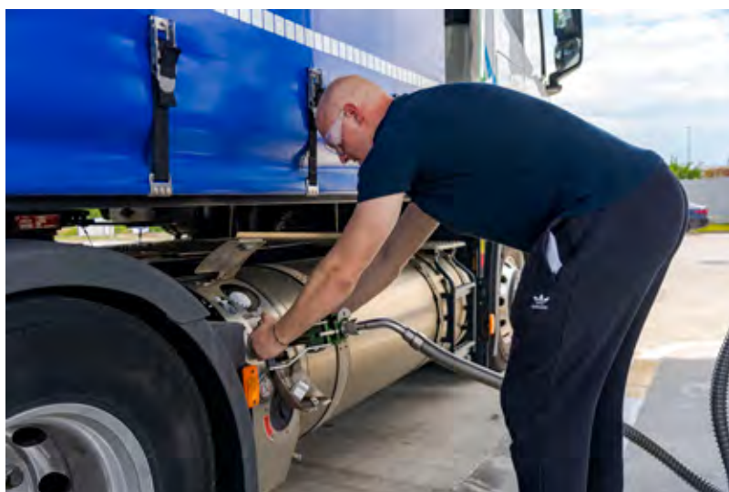
Dva rezervoarja utekočinjenega zemeljskega plina s kapaciteto 540 kilogramov S-Wayu NP zagotavljata avtonomijo do 1.600 kilometrov.
