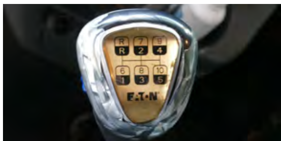
Na ročici menjalnika je napisanih le 10 prestav, a tiste od 6. do 10. imajo polovičke.
