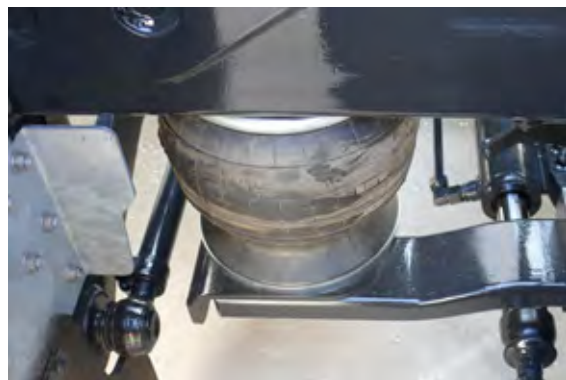
Obe osi sta zračno vzmeteni, kar omogoča dviganje in spuščanje.
