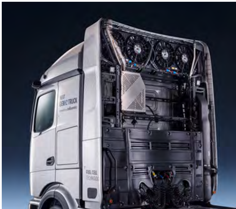
Glavna komponenta je nameščenih v stolpu za kabino, rezervoarji za vodik pa so ob šasiji.
