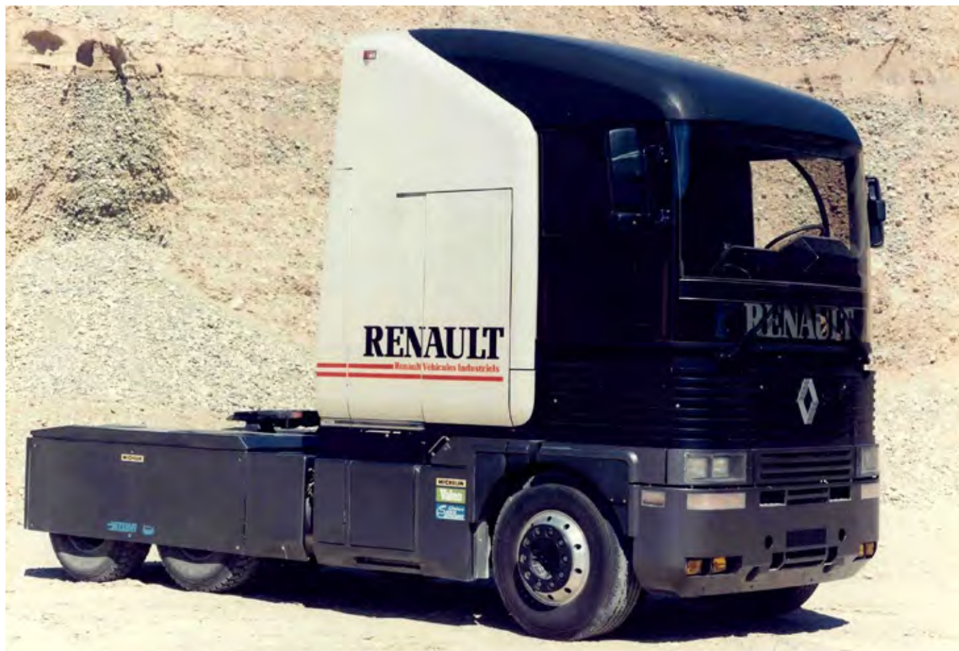
Prvi vozni prototip VE 10 so pri Renaultu izdelali leta 1985.
