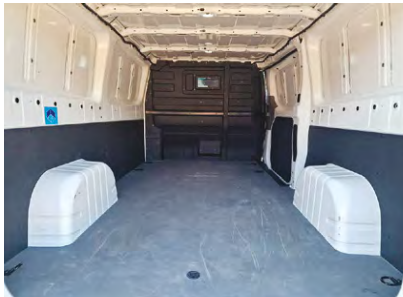
Farizon V7E je električni dostavnik, namenjen predvsem mestni logistiki s tovornim prostorom do 7,5 m³.
