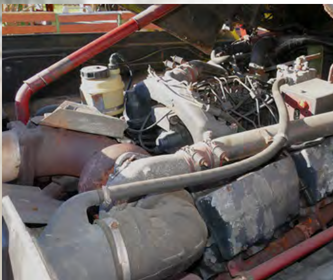
Mackov 8-valjni motor oblike V je pri prvi seriji Renaultov AE zmogel 500 KM (368 kW), kasneje so jo povečali na 520 oziroma 560 KM (382 oziroma 412 kW).
