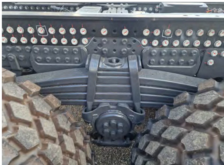
Robustne listnate vzmeti omogočajo delo v najzahtevnejših pogojih, šasija pa je dodatno ojačana.
