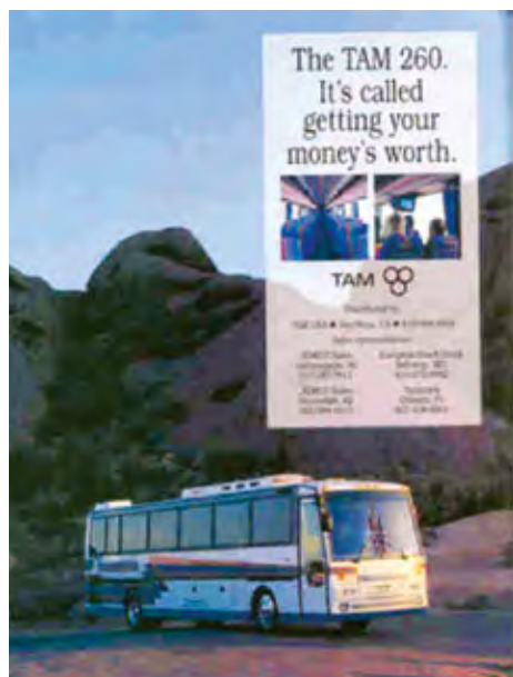
Ameriško izvedbo avtobusa 260 je poganjal Cumminsov motor ter avtomatski ZF-ov menjalnik.
