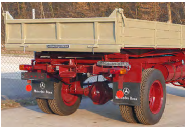
Pogonska os, tovorni zaboj, celo priklop: vse je izvirno. Kar je bilo potrebno, je lastnik obnovil – gibljivi deli imajo nove puše, zavorni sistem je generalno obnovljen ...
