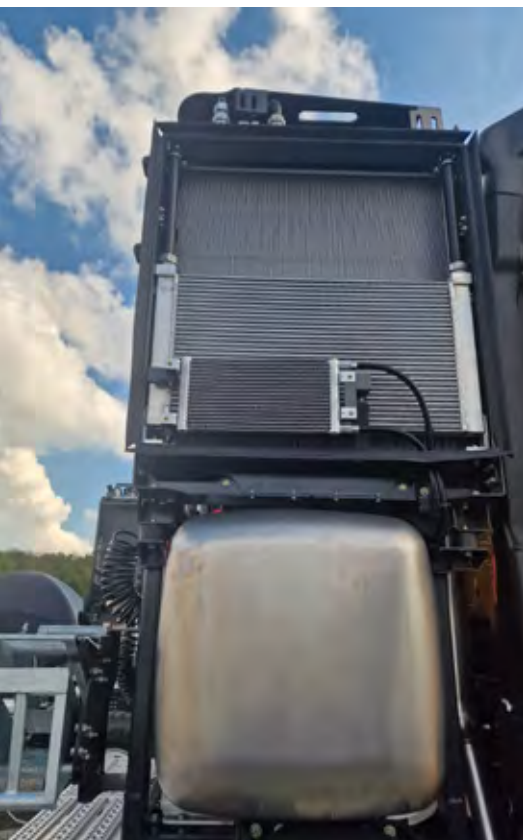
Hladilni sistem je lahko opremljen tudi s hladilnikom dizelskega goriva.
