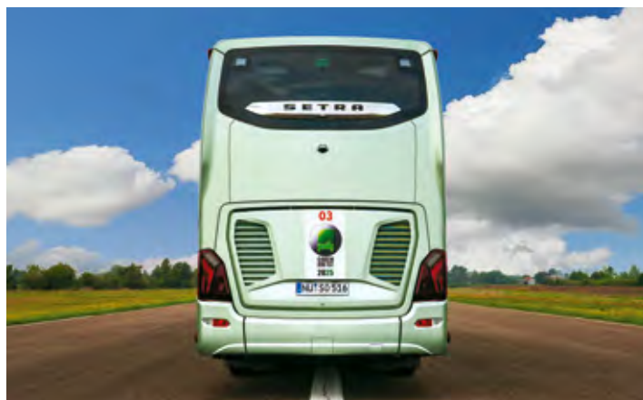
Na zadnjem delu imajo bočni robovi aerodinamične podaljške, ki zmanjšujejo vrtnčenje zraka ter zračni upor.
