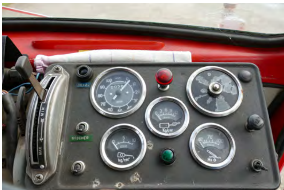
Na armaturni plošči so najnujnejši instrumenti. Na levi je ročni plin, s katerim vozilo tudi ugasmemo.
