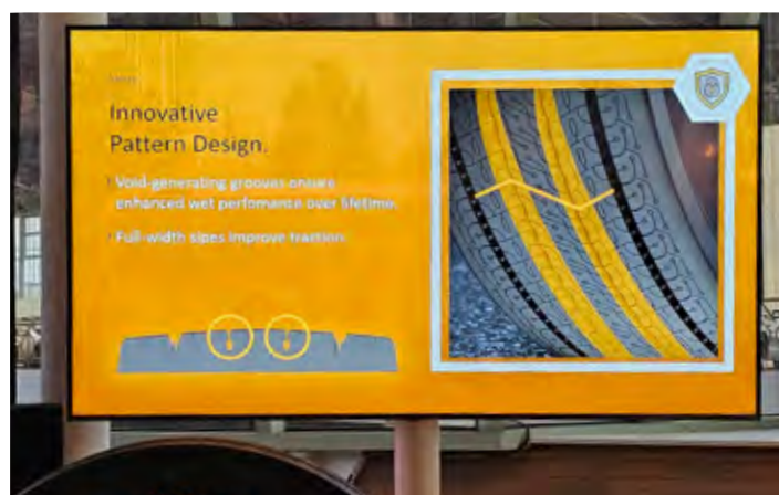
Gosto razporejene lamele zagotavljajo odličen oprijem, ohranjanje smerne stabilnosti in dobro zavorno zmogljivost.
