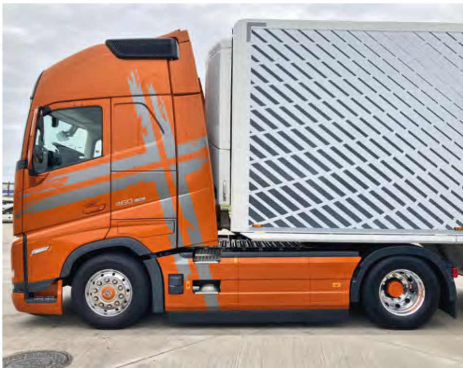
Na isti poti in pri isti povprečni hitrosti je imel FH 460 Aero porabo 20,3 l/100 km, klasični FH 460 I-Save pa 21,1 l/100 km.
