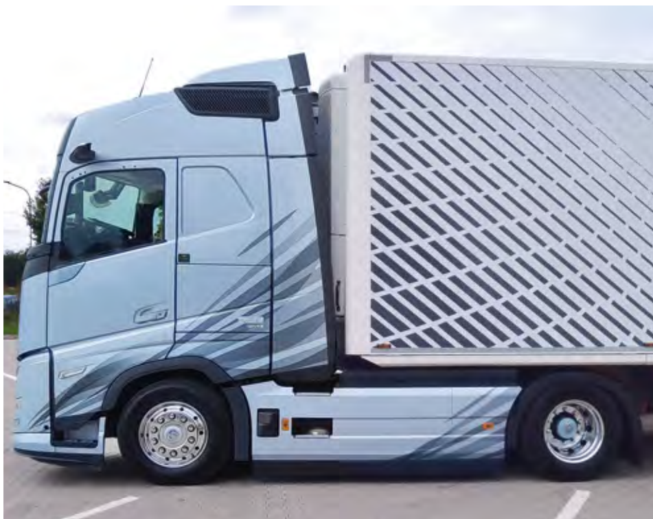
Poleg aerodinamično podaljšane kabine ima FH Aero tudi bolj zaprt prazen prostor med vlačilcem in polpriklopnikom.
