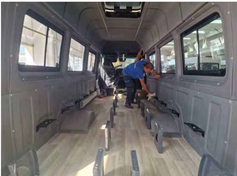
Po vgradnji oken so na vrsti izolacija, napeljave in notranje obloge, sledijo prtljažne police ter sedeži, preden sledi končno testiranje.
