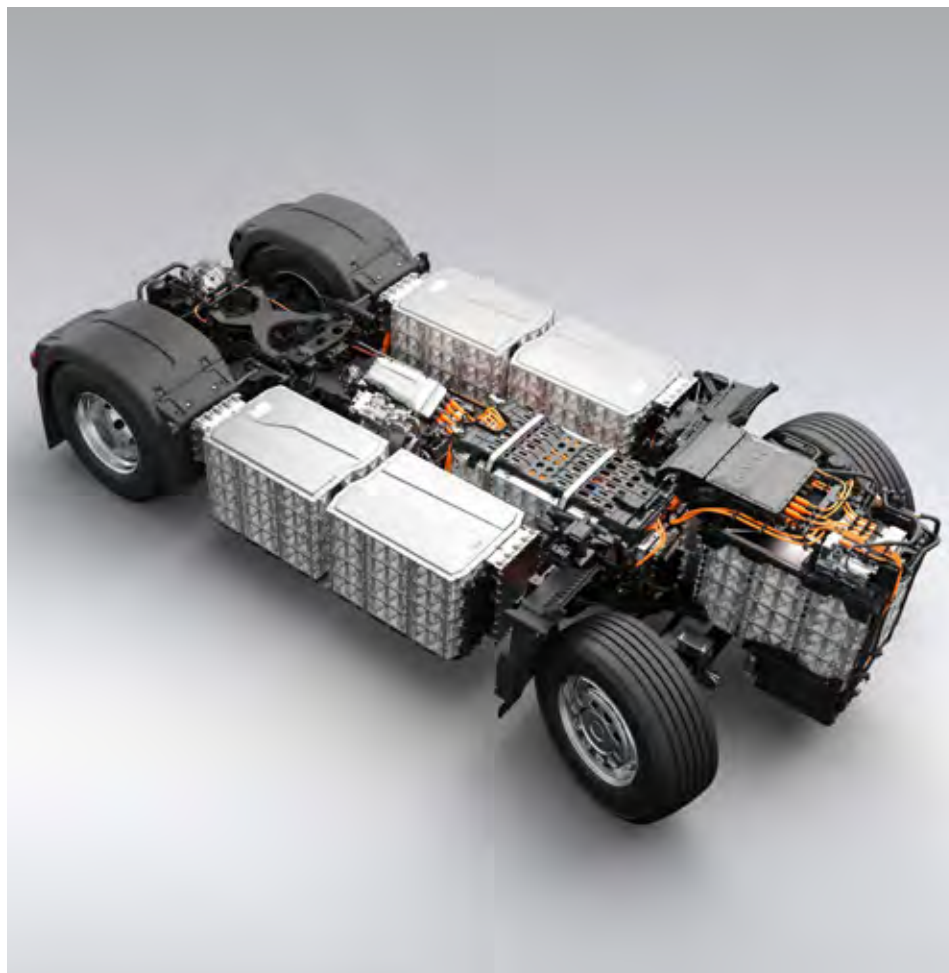
Dva baterijska paketa sta nameščena v sredini šasije (na mestu dizelskega motorja in menjalnika), ostali pa na bokih ob šasiji.
