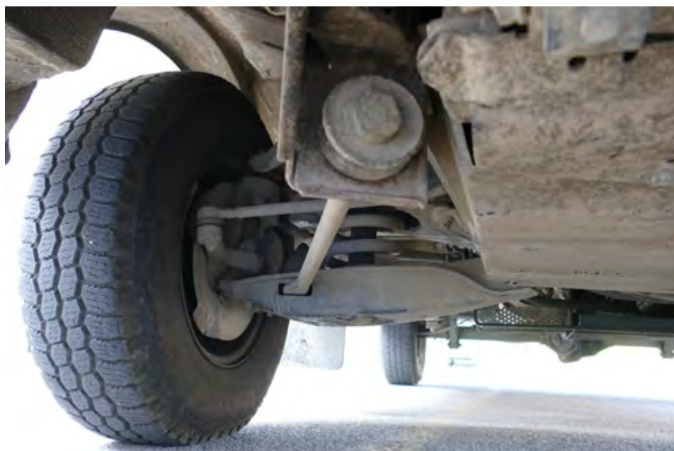
Prednji kolesi sta posamično obešeni – dvojni prečni trikotni vodili, vijačni vzmeti s teleskopskima blažilnikoma in dodatnima vodiloma, prečni stabilizator pa je skrit zadaj.
