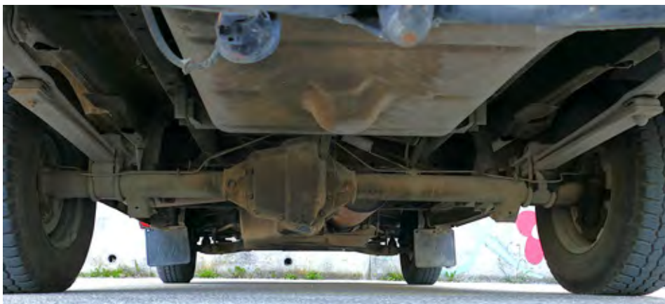
Zadnja pogonska prema potrebuje le malo vzdrževanja in tudi bobnastim zavoram so samo enkrat menjali obloge.
