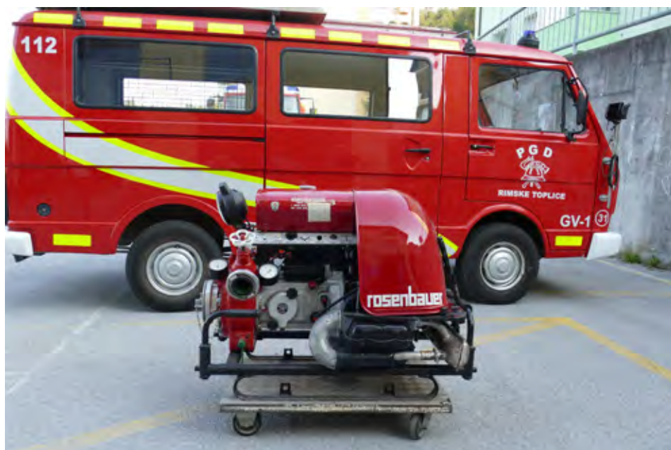
V Avto centru Žunkovič so pri predelavi v gasilsko vozilo v tovorni prostor vgradili brizgalno napravo Rosenbauer, ki še vedno brezhibno deluje.
