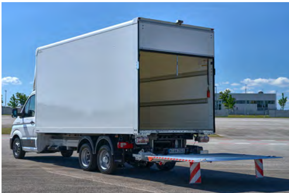
Inovativna rešitev fiksno pritrjene nadgradnje v obliki enoosnega polpriklopnika omogoča vožnjo sedem tonskega vozila z izpitom BE kategorije.
