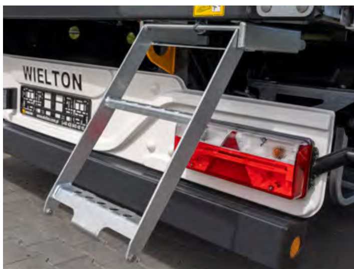
Vstopna lestev se odpira pod kotom in olajša vstopanje in izstopanje.
