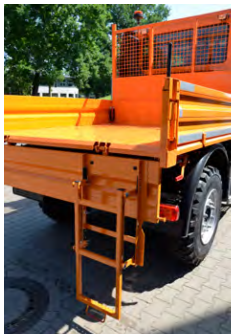
Nižja izvedba nadgradnje olajša nakladanje tovora na keson.
