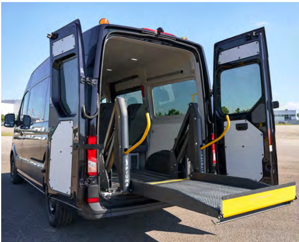
Za prevoz gibalno oviranih oseb na invalidskih vozičkih je mogoče vozila opremiti z električno dvizžno rampo v zadnjem delu.
