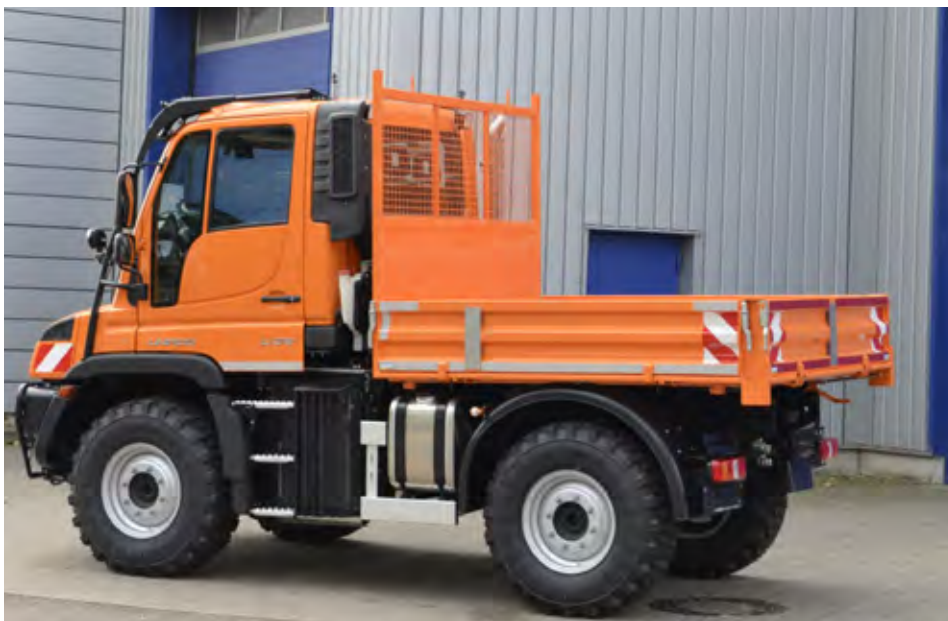
Nadgradnja v obliki tristranega prekucnika proizvajalca Eggers se ponaša z 20 centimetrov manjšo oddaljenostjo od tal, medtem ko je nosilnost nespremenjena.
