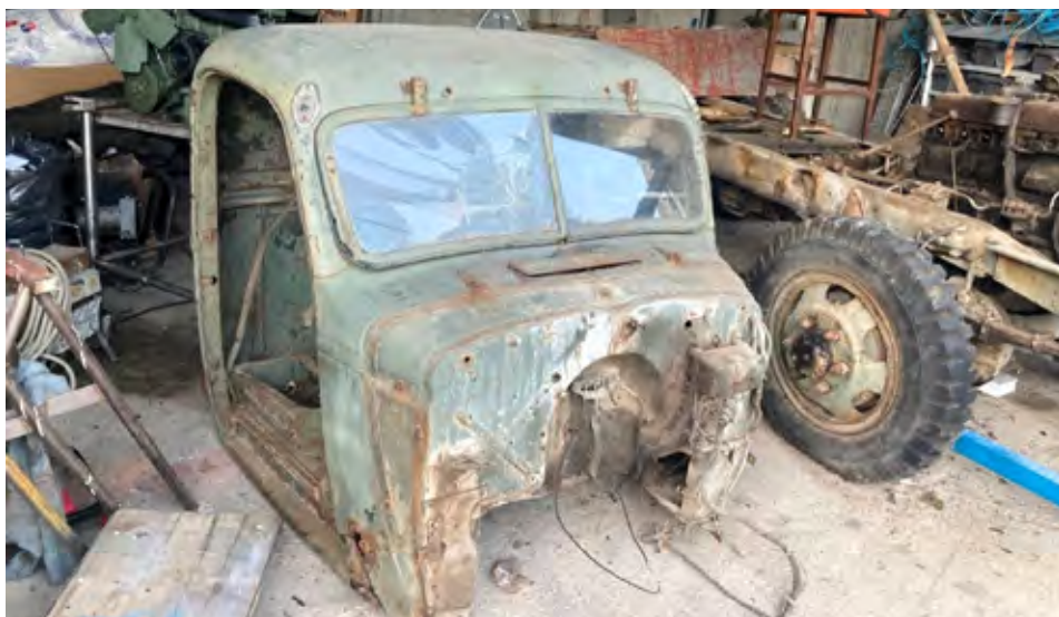
Najprej so odstranili kabino in keson, nato pa nadaljevali z razstavljanjem.
