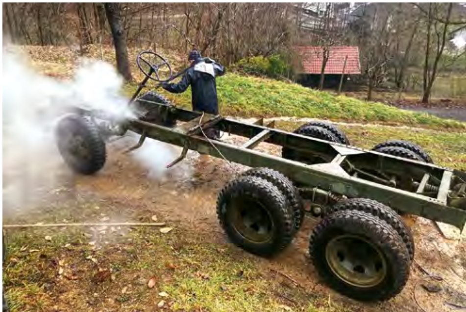
Osnova vozila je močna šasija v obliki lestve, ki stoji na treh pogonskih oseh.
