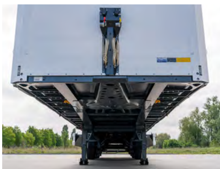
KTL zaščita robustne šasije in komponente priznanih proizvajalcev prikolici zagotavljajo dolgo življenjsko dobo.
