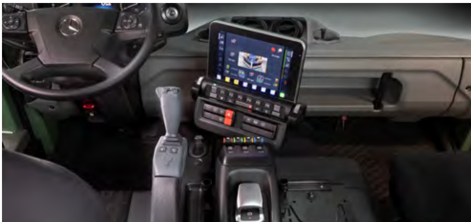
Unimog Low je opremljen z novim operacijskim sistemom UNI-TOUCH, ki omogoča učinkovitejše in udobnejše upravljanje priključkov.
