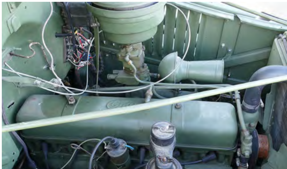
4,4-litrski motor je v štiridesetih letih prejšnjega stoletja veljal za sodobnega, saj je ventile imel že v glavi (zasnova OHV).
