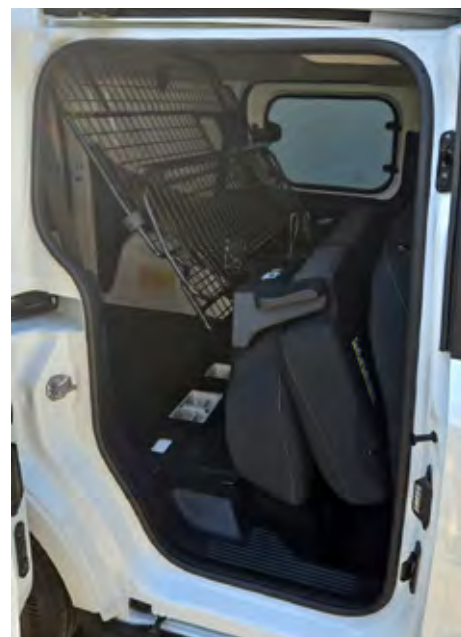
Zložljiva predelna stena povečuje tovarni prostor.
