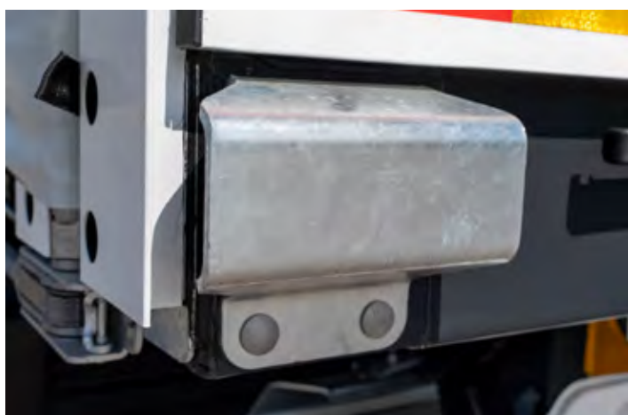
Jekleni pocinkani odbojniki preprečujejo poškodbe šasije pri parkiranju na nakladalne rampe.
