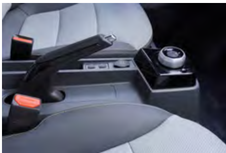
Okrogli regulator voznih programov, vtičnice za zunanje porabnike in klasična parkirna zavora med sedežema.
