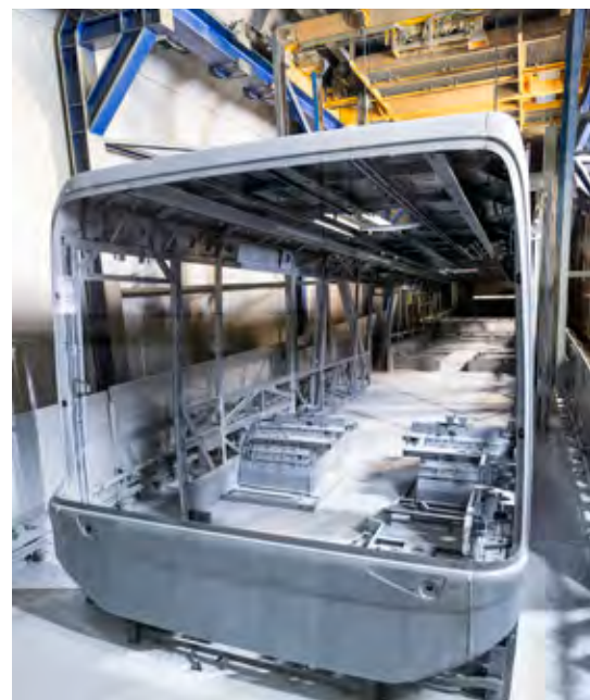
Tovarna se lahko pohvali z bazenom za kataforezno potapljanje celotnih karoserij avtobusov (KTL).
