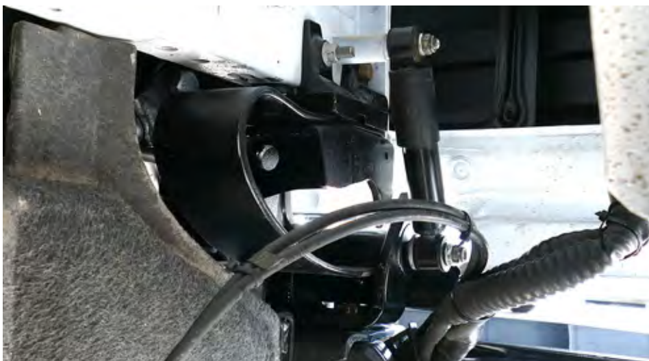
Jekleni vzmeti kabine z blažilcema se ne moreta kosati s sodobnimi zračno vzmetenimi nogami.
