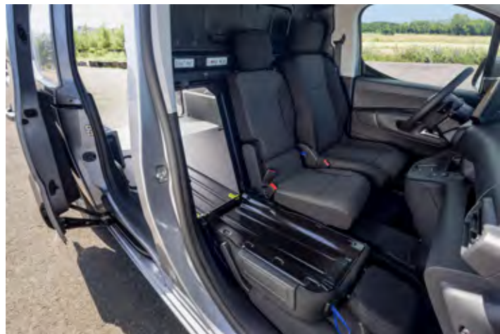
Combo ponuja odprtino v pregradni steni, ki omogoča prevoz daljših tovorov.
