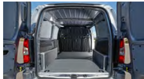
Na voljo je različica s standardno nosilnostjo do 650 kg, ter različica s povečano nosilnostjo do 1.000 kg.
