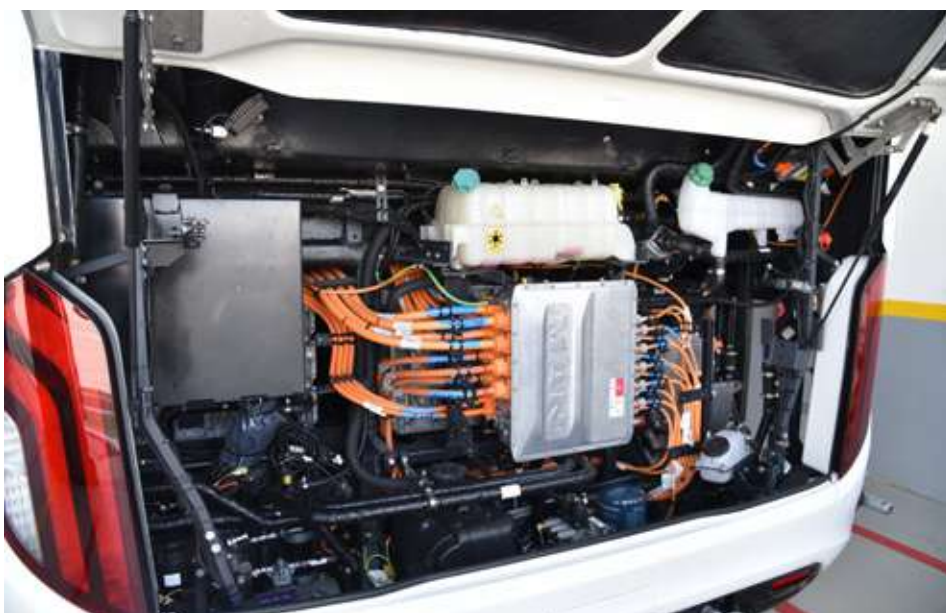
Krmilna elektronika ter hladilni sistemi so v zadku avtobusa.
