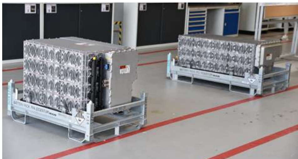
MAN je v Nürnbergu zagnal lastno proizvodnjo baterijskih modulov, ki so lahko dveh različnih velikosti. Kapaciteta posameznega modula je 89 kWh, njegova teža pa znaša 630 kilogramov.
