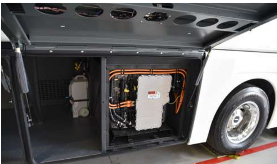
Pomembna lastnost električnega avtobusa je, da tudi če je ta opremljen z maksimalnim številom šestih baterijskih modulov, ostaja prostornina prtljažnega prostora identična tisti pri dizelskem avtobusu.
