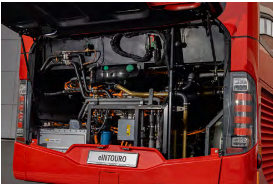
V zadku se nahaja krmilna elektronika in opsijski drugi baterijski paket, vgrajen vzdolžno na levem boku.
