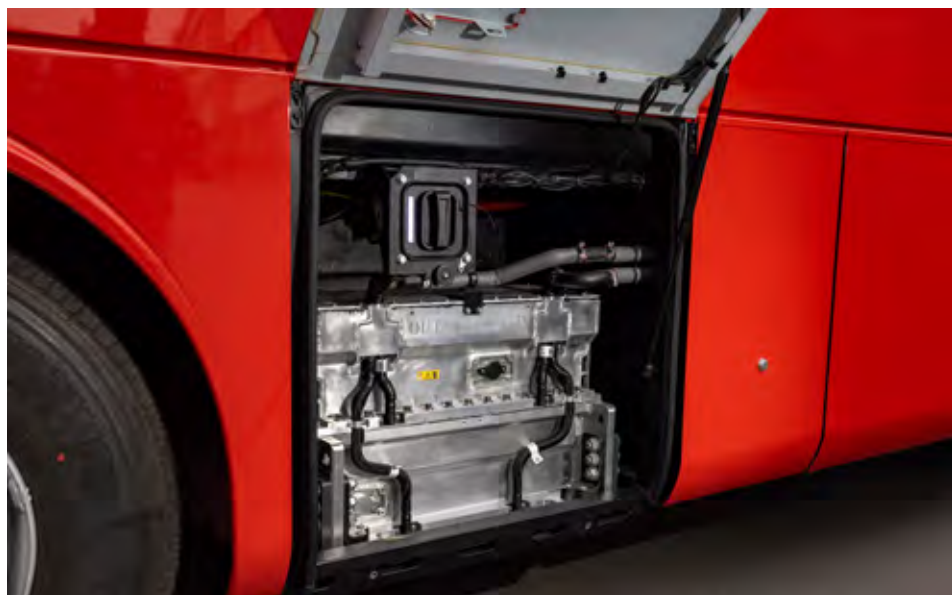
V zadku se nahaja krmilna elektronika in opsijski drugi baterijski paket, vgrajen vzdolžno na levem boku.
