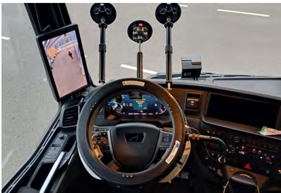
Sistem kamer namesto klasičnih vzvratnih ogledal zmanjšuje mrtve kote in s tem povečuje varnost
