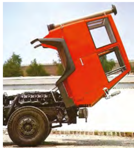
V seriji 90 so imeli prekucno kabino samo tovornjaki z 8-valjnimi motorji, v seriji 91 pa vsi.
