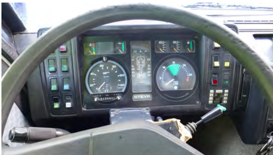
Armaturna plošča je bila v času, ko so ga dali na trg, sodobna. Tovornjak nima šipke za raven olja v karterju, ker jo meri senzor in podatek pokaže na armaturni plošči, ko damo kontakt.
