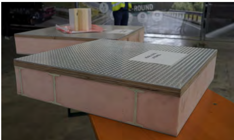
Del sistema hladilne prikolice je tudi nova zasnova talnega panela, v katerem so klasične lesene nosilce nadomestili z nosilci iz polimera s steklenimi vlakni.
