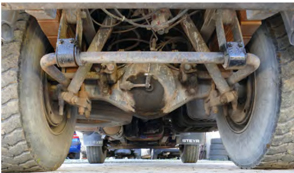
Da gre za trdoživo vozilo, priča že pogled pod šasijo – pogonska os je zajetna, na vsaki strani skladovalnica listov vzmeti in zelo debel prečni stabilizator – pri prekucniku pride prav.
