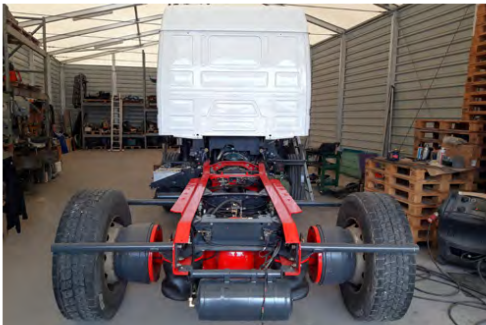
Začetek poletja 2023 je Vine na obnovljeno podvozje že zmontiral kabino.
