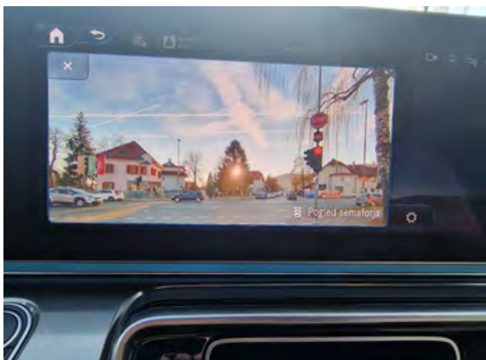
Še ena od odličnih rešitev, sprednja kamera, preko katere voznik lažje vidi na semafor.
