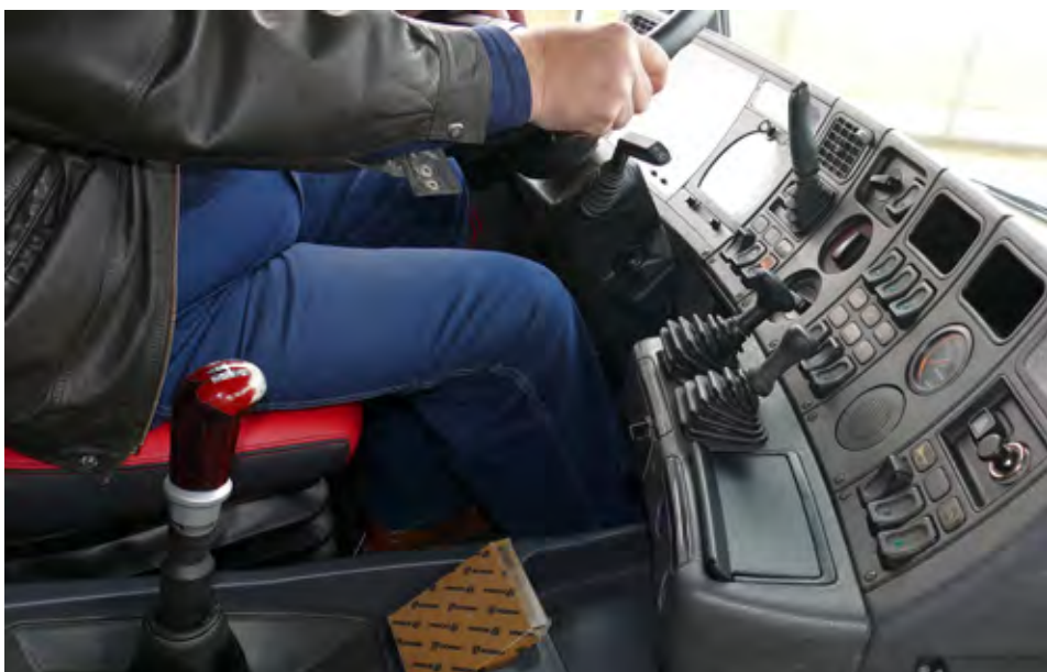
Ročica menjalnika ima šest stopenj s polovičkami. Največji vzvod na armaturni plošči (desno od volana) ukazuje retarderju, pod njim je na levi vzvod ročne zavore, na desni pa tako imenovana tramvajska zavora.
