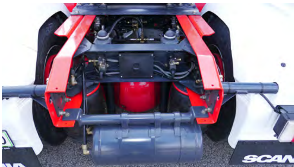
Tovornjak je videti kot nov – nov prečni nosilec šasije, nova nosilca zadnjih blatnikov, novi zračni vzmeti ...
