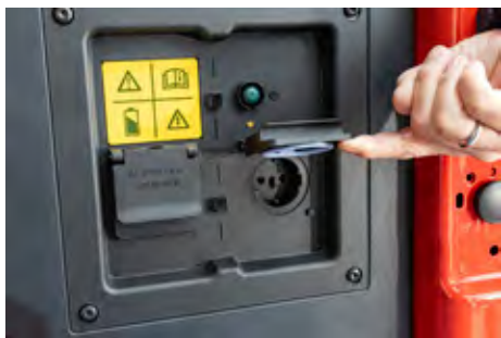
Električne izvedbe omogočajo napajanje zunanjih naprav ali orodja.
