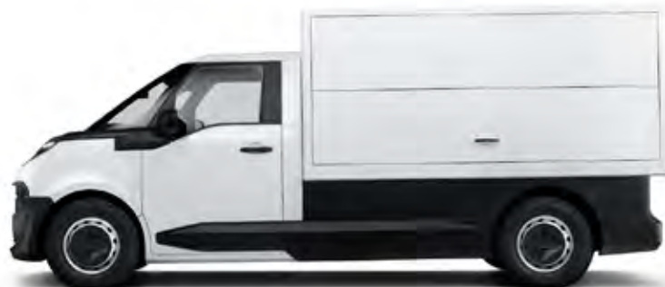
Elektromotor moči 150 kilovatov poganja zadnja kolesa, predvidena je možnost vgradnje NMC ali LFP baterij.
