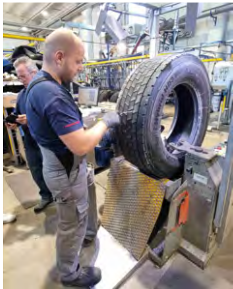
Na pripravljeno karkaso se nanese plast lepilne gume, nato pa predvulkaniziran tekalni sloj.
