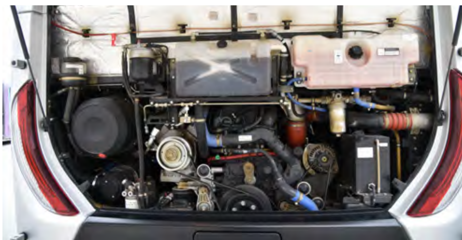
Sodoben Ivecov vrstni šestvaljni motor Cursor 9 slovit kot ekonomičen agregat in ponuja dobre vozne zmogljivosti.
