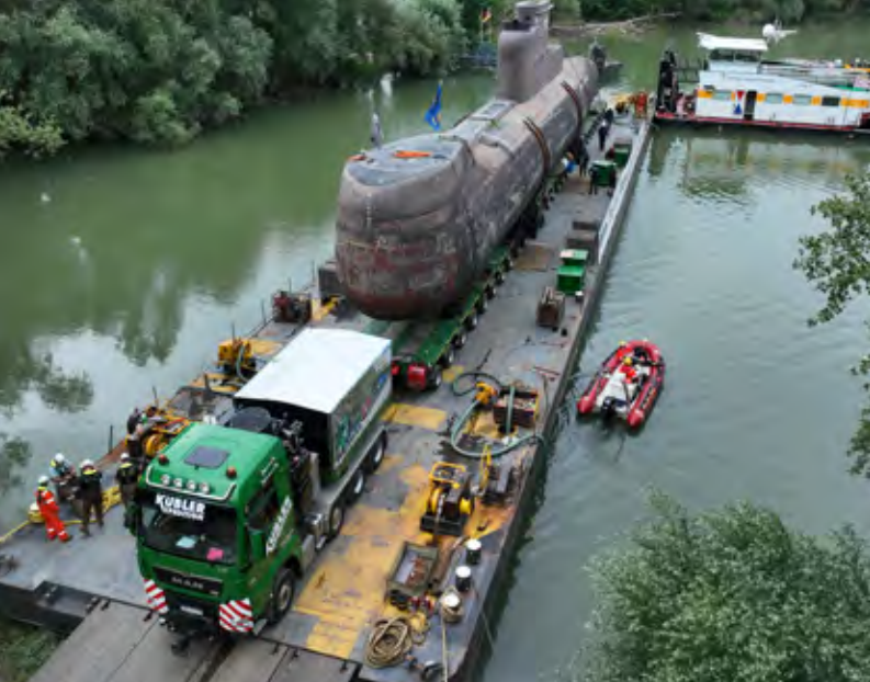
Na vodi mora posadka ohranjeti ravnotežje ne le podmornice, ampak tudi pontona – ta je bil dolg 66 metrov in širok 11,5 metra.
