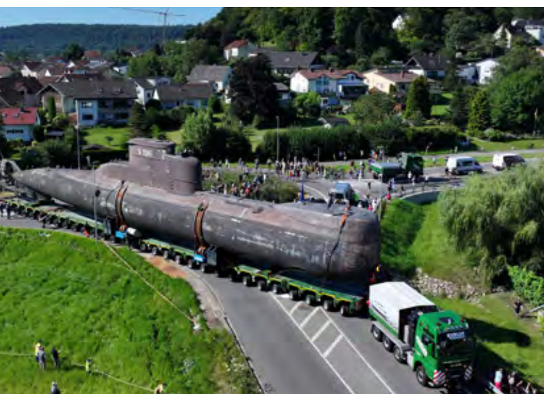
Kompozicijo je spredaj vlek specialni vlačilec za izredne prevoze MAN TGX 41.680 v pogonski konfiguraciji 8x6, po potrebi pa sta mu s potiskanjem na zadnjem delu prikolice pomagala tudi eden ali dva štiriosna tovornjaka Mercedes-Benz Actros SLT s 610 konjskimi močmi.
