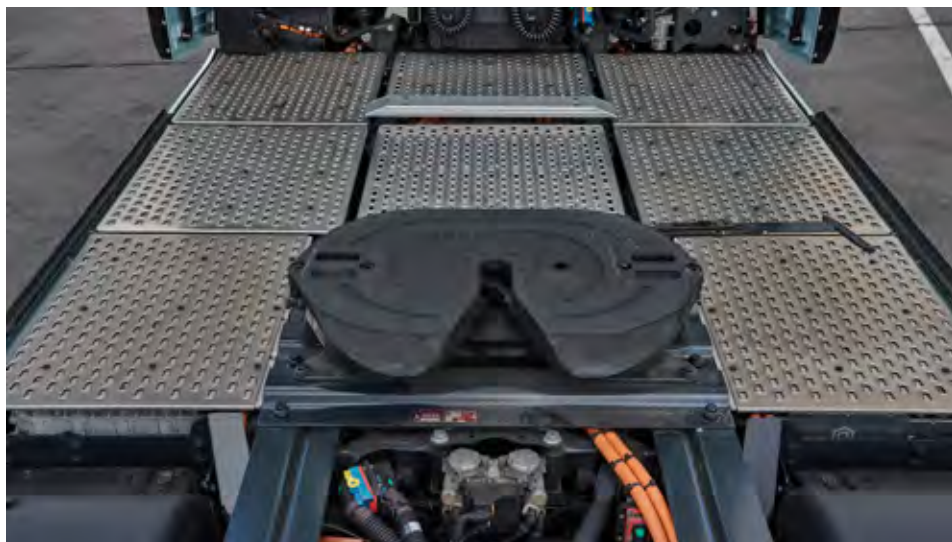
Zaradi električne osi je na šasiji prostora za kar devet baterijskih paketov s kapaciteto 738 kWh.
