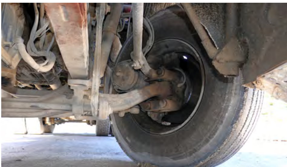
Tovornjak ima na vseh kolesih kolutne zavore. Serijsko sta prednji vzmeti imeli po tri liste, da so ga malo dvignili, so dokupili še enega (4-listna parabolična vzmet).
