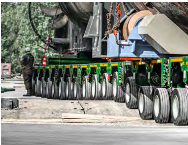
Hidravlično vzmetenje posamičnih osi prikolice Scheuerle InterCombi, omogoča 65-centimterski hod osi, s čimer so lahko kompenzirali višinsko razliko med pontonom in kopnim.
