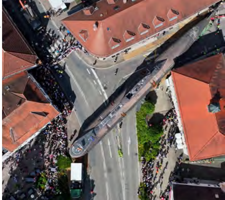
Ekipa manevrira s približno 530 ton težko, 90 metrov dolgo in 10 metrov visoko kompozicijo, ne samo pod mostovi, ampak tudi skozi najožje ulice slikovite pokrajine Kraichgau.
