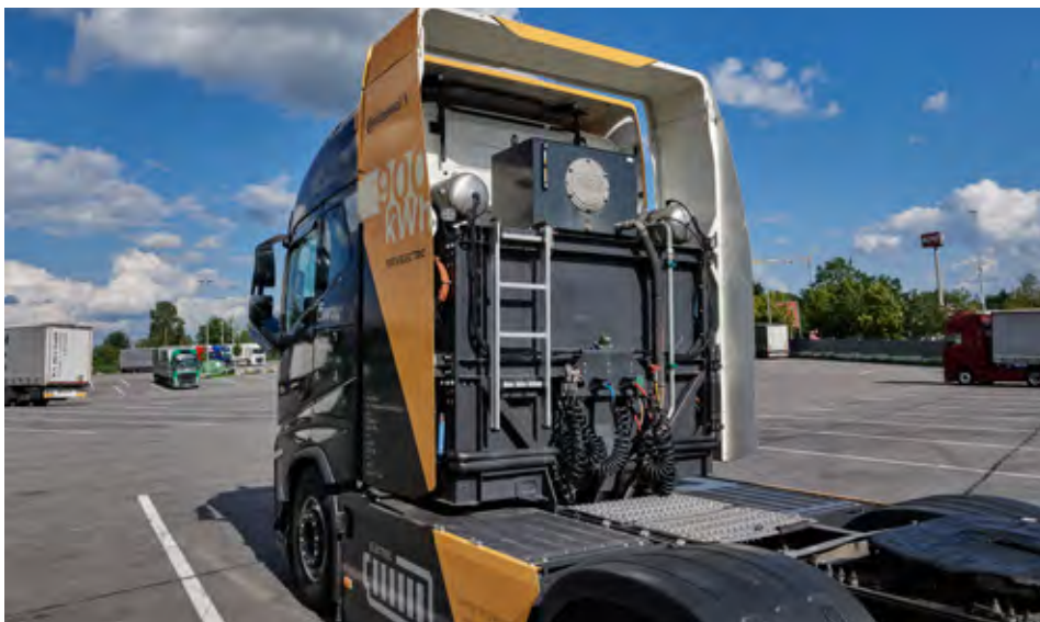
Dve od štirih baterij je Designwerk namestil v stolp za kabino, zato je potrebna daljša šasija.
