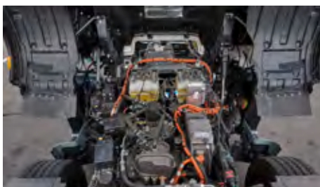
Vse pomožne naprave so nameščene pod kabino.
