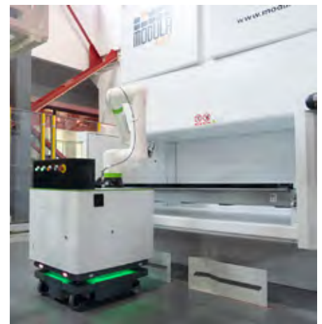
AMR z robotsko roko integriran z MODULA sistemom.
