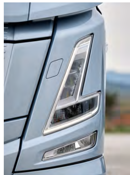
Volvo opsijsko ponuja matrice LED žaromete, ki izboljšujejo nočno vidljivost.
