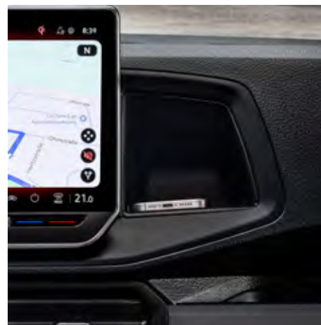
Odlagalni predal omogoča induktivno polnjenje mobilnih naprav.
