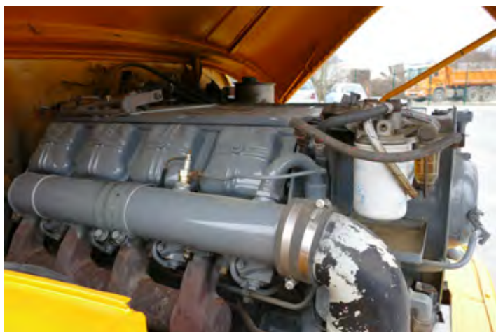
Tako Tatrin kot Tamov motor sta zračno hlajena osemvaljnika, zato zamenjan motor opazijo le poznavalci. Je pa res, da Tamov ne žvižga tako kot Tatrin.
