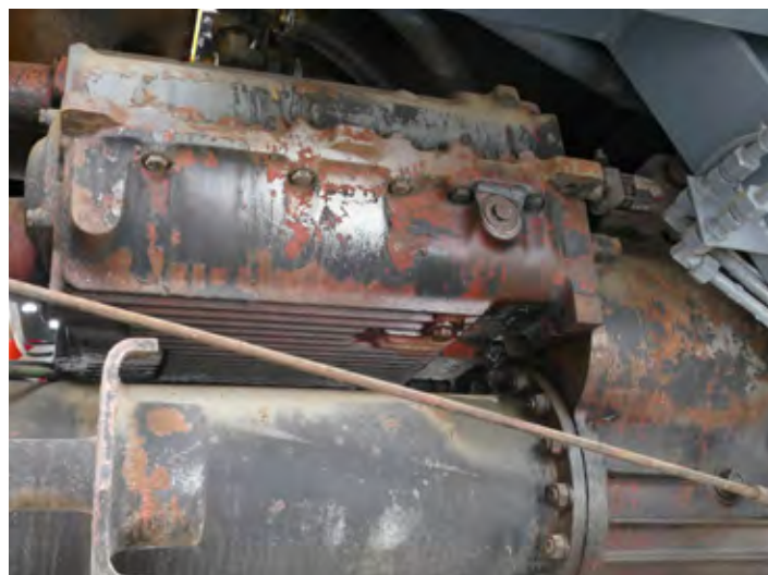
Menjalnik so namestili na zunanjo stran 'hrbtenične cevi'.
