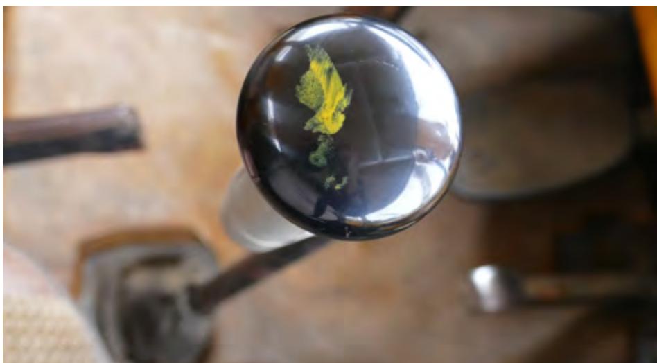
Ročica menjalnika je pošteno obrabljena, z njo izbiramo med petimi hitrimi in petimi počasnimi prestavami. S slednjimi Tatra prileze po še tako slabem terenu.
