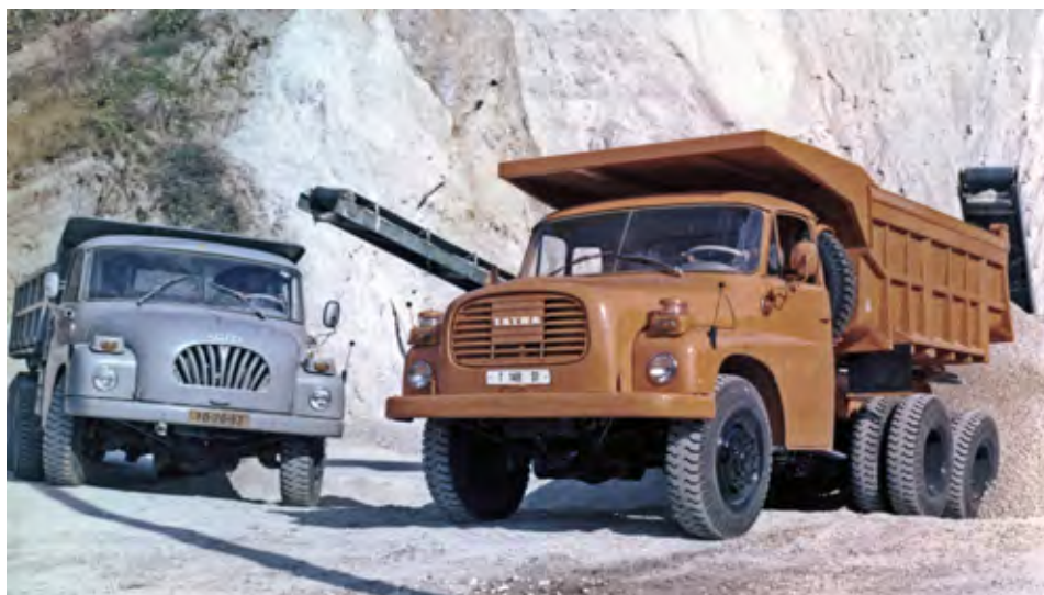
Na zunaj se je stari model T 138 (levo) od novega T 148 razlikoval po bolj zaobljenem motornem pokrovu in manjši odprtini za hladilni zrak (maski).
