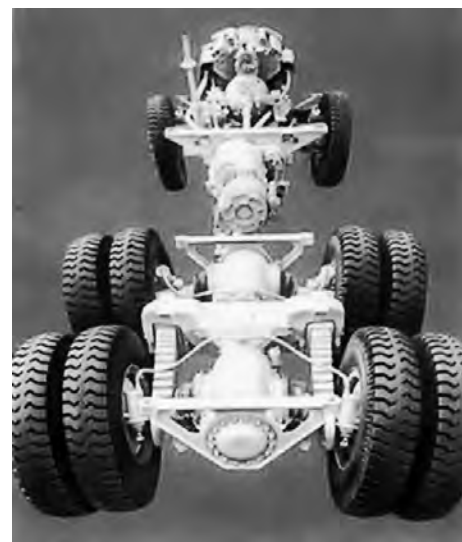
Podvozje z vsemi kolesi na nihajnih premah in s 'hrbtenečno cevjo' namesto klasične šasije je bilo pri modelih T 138 in T 148 tako rekoč identično.
