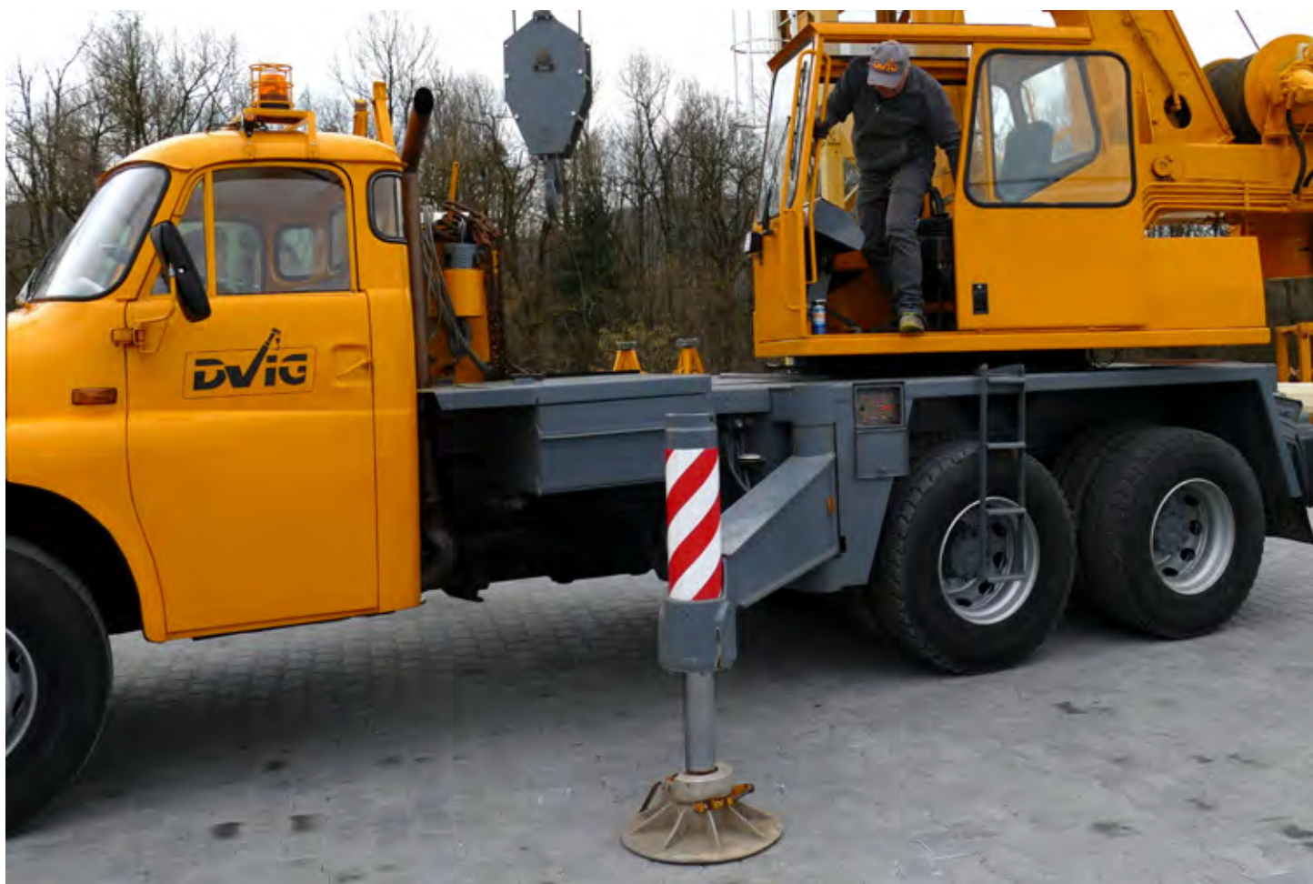
Prednji nogi za stabilizacijo dvigala je bilo treba pri novem vozilu ročno izvleči, zato so pri Dvigu vgradili dodatna hidravlična valja.
