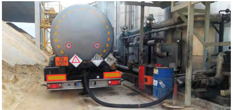
Cev za praznjenje cisterne je treba priklopljati z veliko mero previdnosti. Tudi ko Danny pripelje na cilj, je temperatura bitumna še vedno blizu 180 °C.
