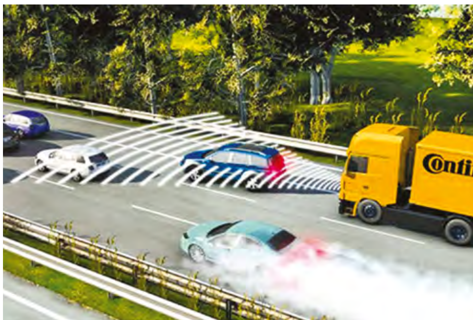
Aktivna asistenca za zaviranje v sili preprečuje prometne nesreče z naletom in močno zmanjšuje verjetno hujših telesnih poškodb.
