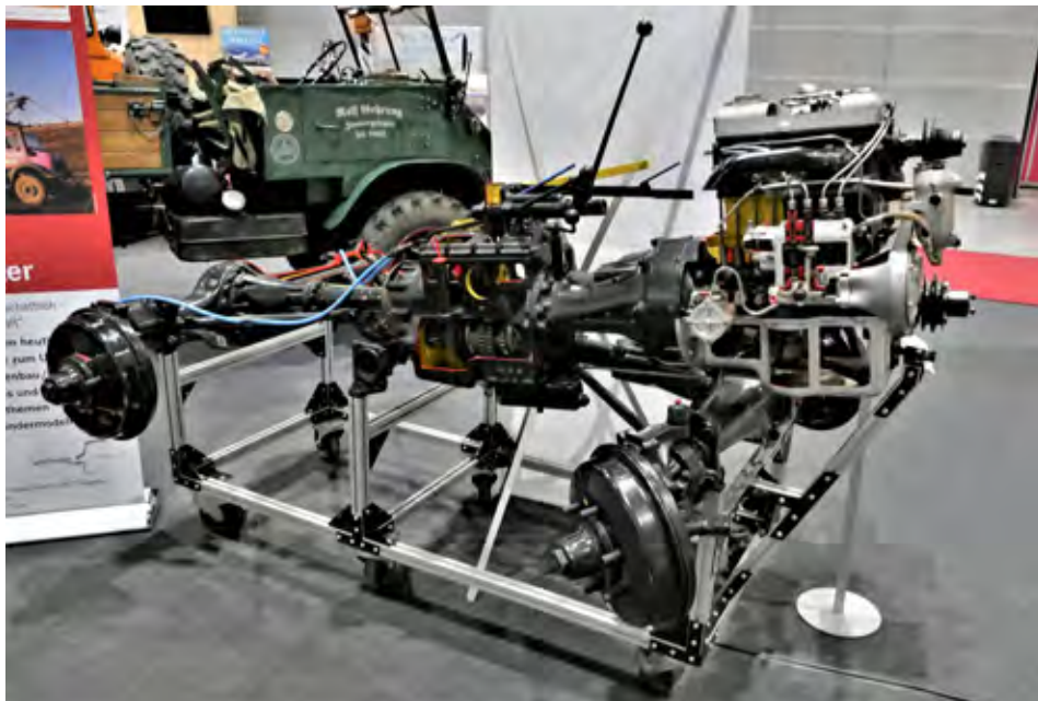
Prerez modela Unimog 2010, ki so ga prikazali v Stuttgartu na Retro Classicsu leta 2019 in je bil praktično enak prototipu – le da je prototip imel bencinski motor.
