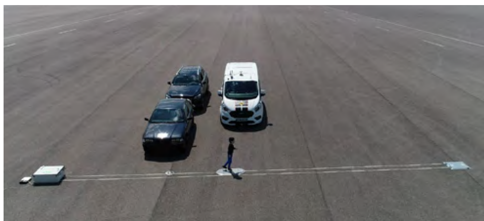
Sistem zmore samodejno zavirati in se varno ustaviti pred morebitno oviro.
