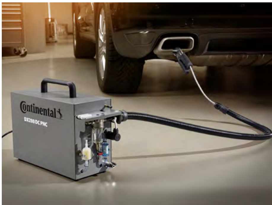
Pri Continentalu so za štetje trdnih delcev razvili napravo DX280 DC.
