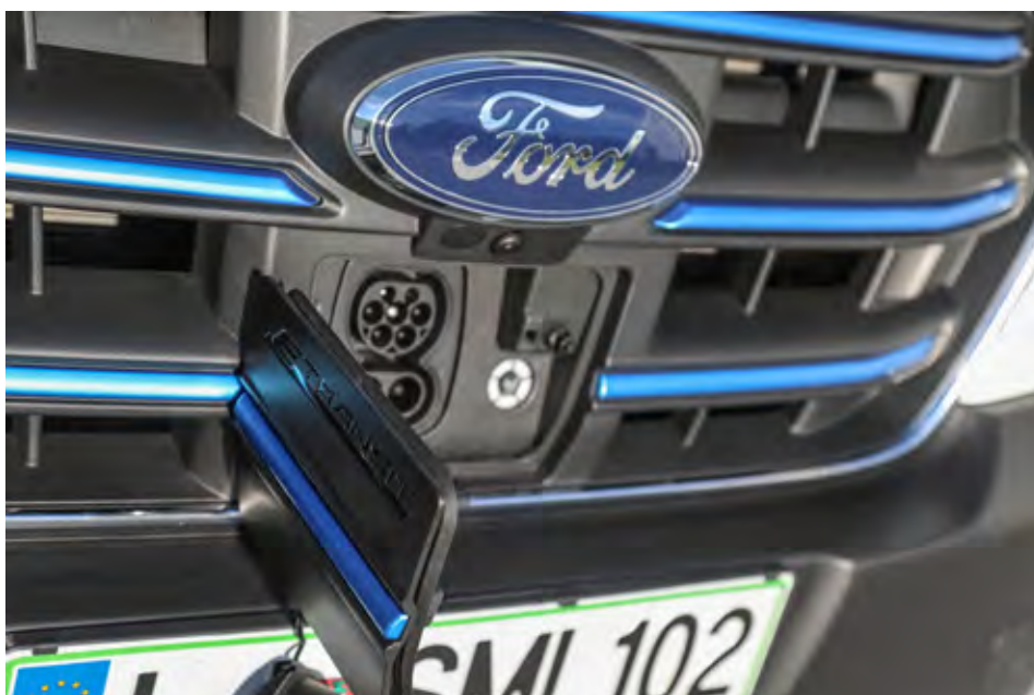
Polnjenje preko klasične polnilnice z 11 kilovatov, z enosmernim tokom do 115 kilovatov.
