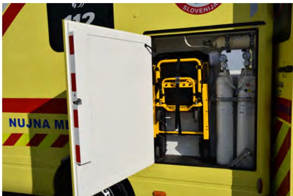
Na levem boku se nahaja predal z zložljivim vozičkom za transport pacientov po stopnicah ali drugih tesnih prostorih ter jeklenkami s kisikom.
