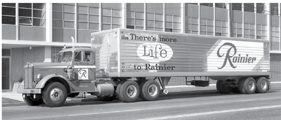
S plastičnim naprej prekucnim pokrovom, v katerem so bili združeni motorni prostor, blatnika in maska, je bil Kenworth 900 leta 1956 zelo sodoben tovornjak.
