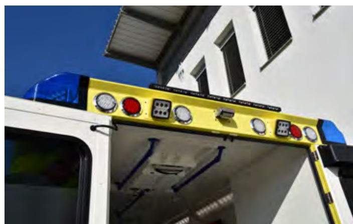
Za celotno zunanjo razsvetljavo skrbijo LED diode, na zadku je še kamera za vzvratno vožnjo ter usmerjevalna tabla za usmerjanje prometa.
