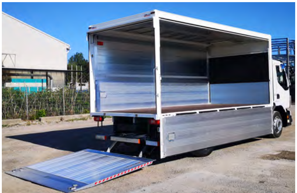
Nadgradnja za prevoz pijač nudi zlaganje zgornje stranice pod strop in je lahko opremljena z zmogljivo nakladalno ploščadjo zadaj, ki je primerna za težke tovore.
