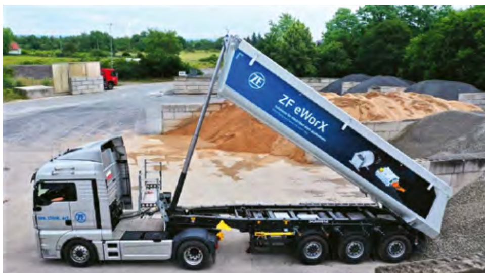
Ker je prototipni eWorX vlekel klasičen vlačilec, so pod polpriklonik dodali še baterijo, zmogljivosti 17 kWh.
