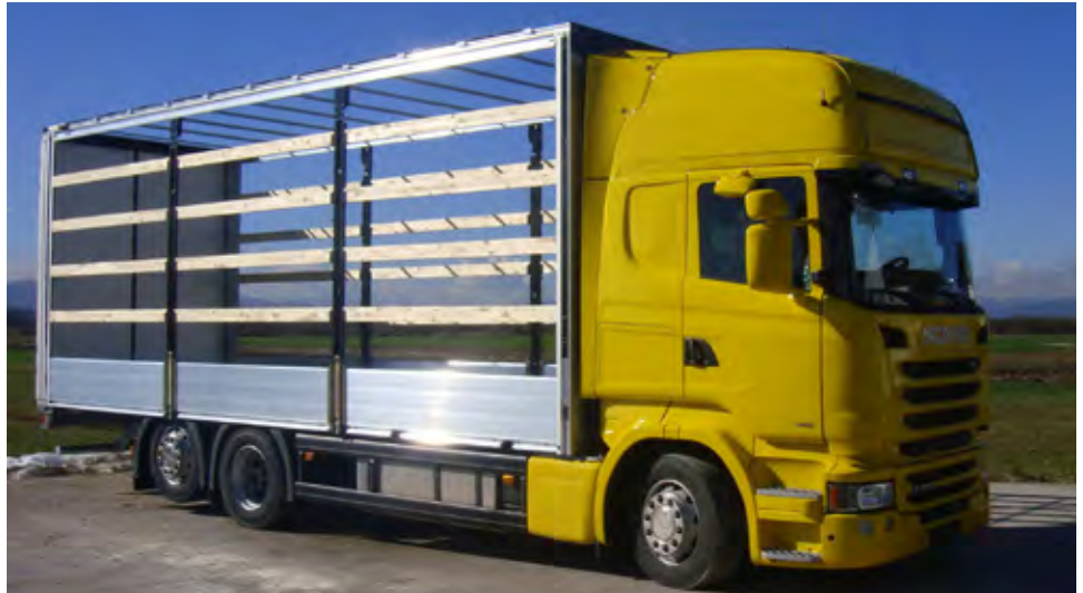
Lahke nadgradnje za tovorna vozila Vestro, so lahko opremljene z dvizno streho in imajo obrobni profil izdelan iz nerjavečega inox jekla.
