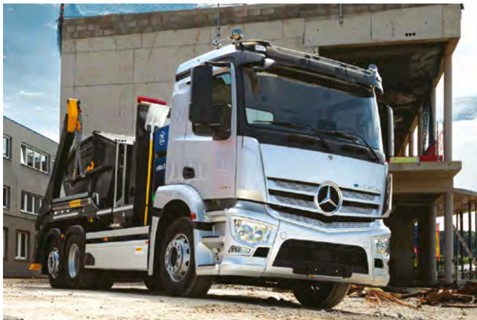
Vse na elektriko: eActros + eWorX za pogon hidravlike za nakladanje in razkladanje odprtih zabojnikov.
