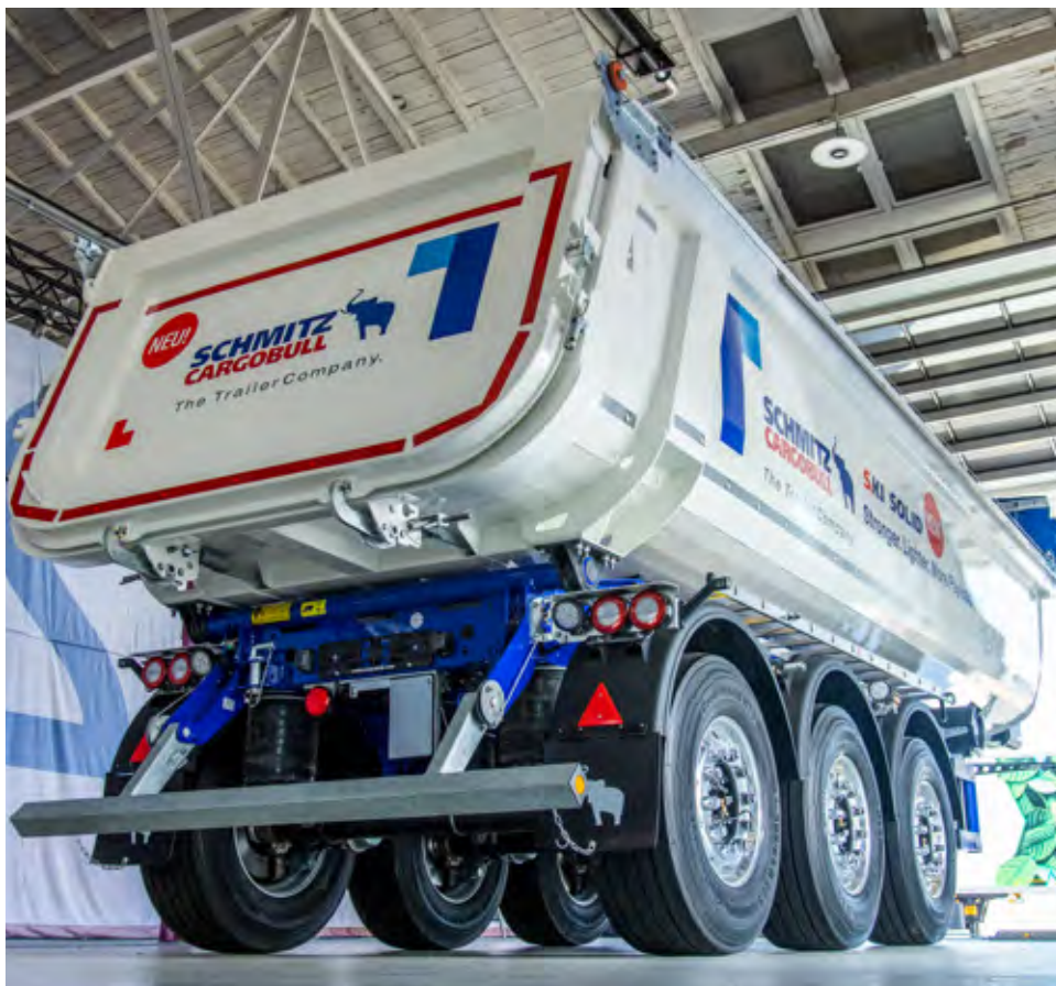
Prekucniki so opremljeni z novo generacijo šasij in kesonov, ki omogočajo do 230 kilogramov prihranka pri masi.
