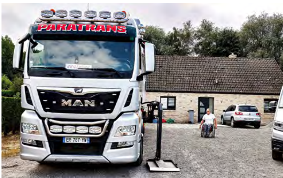
Posebna platforma omogoča, da se z vozičkom v vozilo povzpne v nekaj sekundah.
