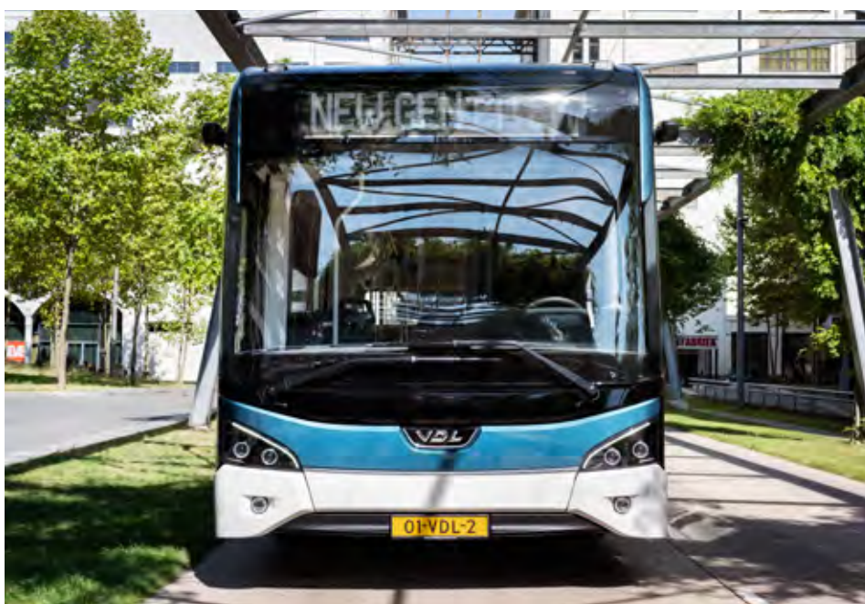
Kapaciteta baterij je lahko do 674 kWh, avtobus pa omogoča 24-urno obratovanje brez vmesnega polnjenja.
