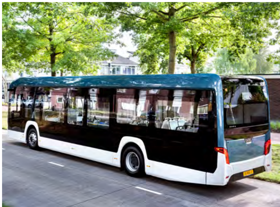
Stranske stene avtobusa so izdelane iz lahkega kompozita, ki ga je mogoče reciklirati.
