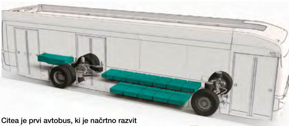
Avtobus poganja ZF-ov centralni elektromotor CeTrax, pri v celoti nizkopodnih modelih pa integrirani motorji v portalni pogonski osi AxTrax.
