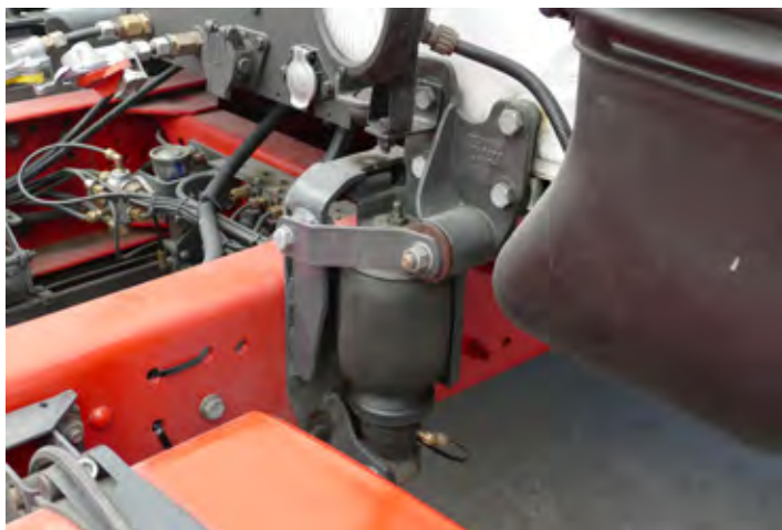
Kabina je zračno vzmetena samo na zadnjem delu, a je vseeno udobna.
