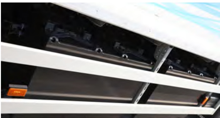
Baterije so vgrajene v jeklene zaboje, ki so nameščeni ob šasiji na obeh bokih tovornjaka.
