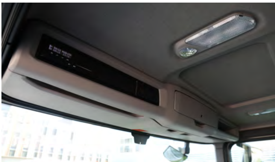
Kljub nizki strehi, sta nad vetrobranskim steklom dva manjša shranjevalna predala, en odprt in en zaprt.
