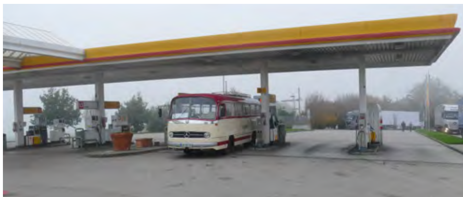
Na črpalki blizu Rosenheima smo prvič dolili gorivo in ugotovili, da poraba ni dosegla niti 16 l/100 kilometrov – poraba po tovarniških normah je znašala 15 l/100 kilometrov.
