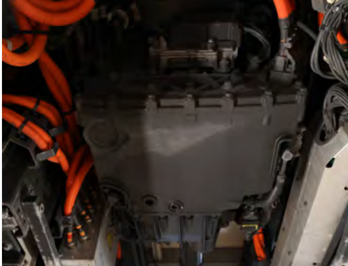
Centralni elektromotor z integriranim menjalnikom je vgrajen pod šasijo.
