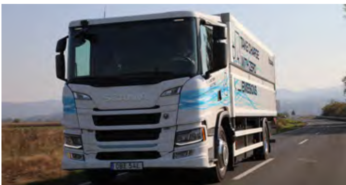
Električna Scania ima dve prestavni razmerji, med prvo in drugo prestavo pa avtomatika preklopi pri hitrosti okoli 30 km/h.
