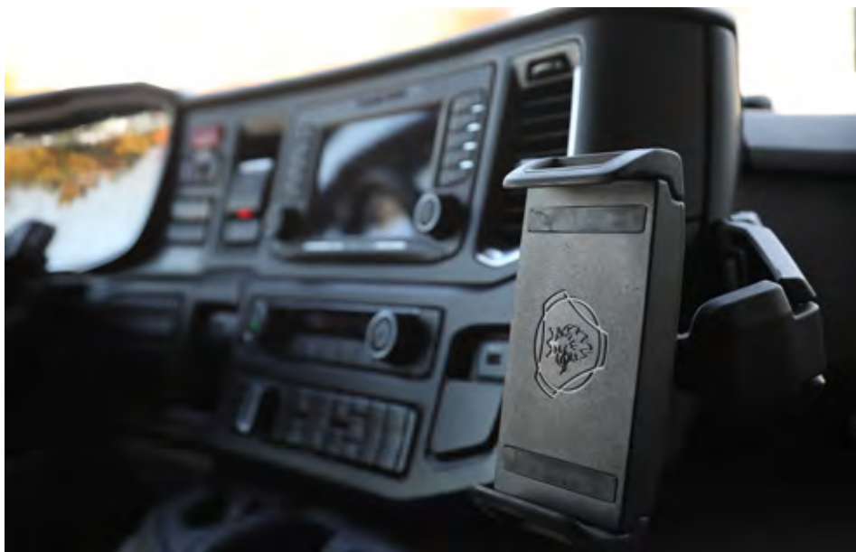
Praktičen nosilec omogoča varno namestitvev mobilnega telefona, ki ga voznik lahko poveže z infotainment sistemom tovarnjaka.
