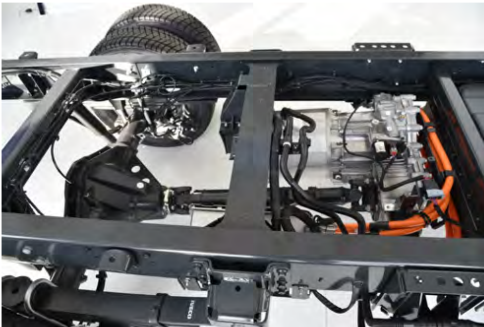
Centralni elektromotor preko kardana poganja zadnjo os, eDaily pa je edini električni dostavnik, ki ponuja izbiro prenosnega razmerja pogonske osi.
