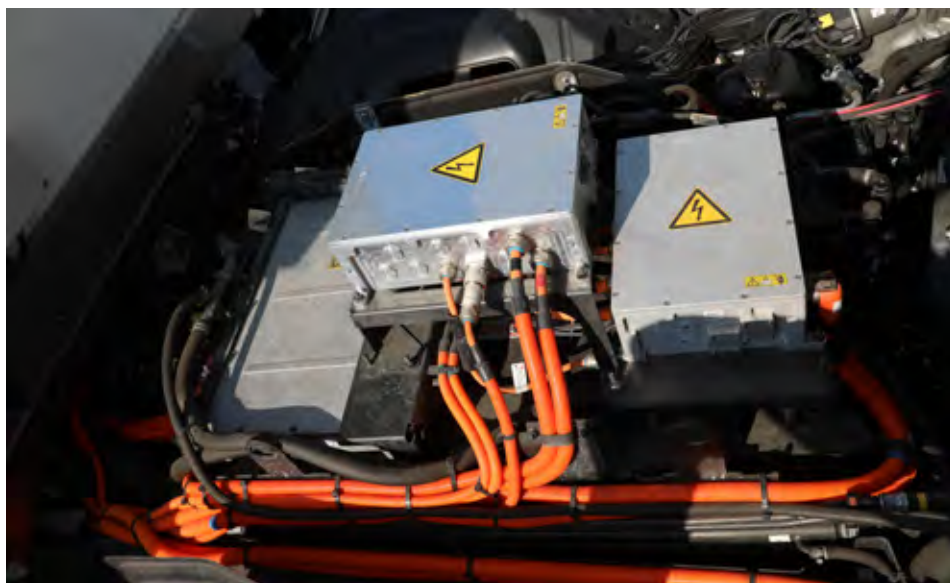
Pod kabino, kjer je sicer prostor za dizelski motor, so pri električnem tovornjaku vgrajene komponente krmilne elektronike.
