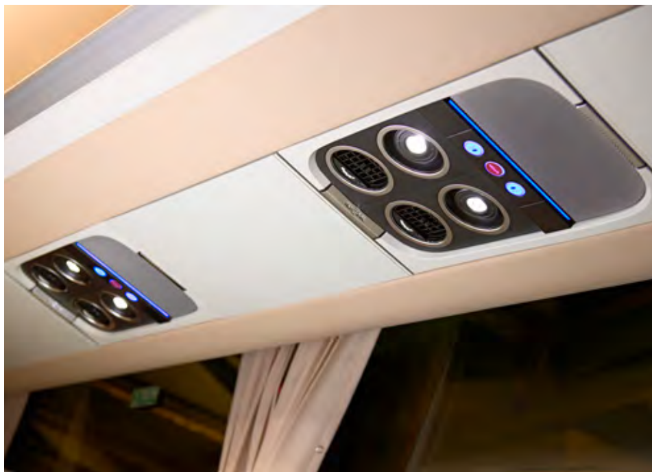
Nova klimatska naprava proizvaja od šest do deset decibelov manj hrupa in je, odvisno od modela, lahko integrirana v streho avtobusa.
