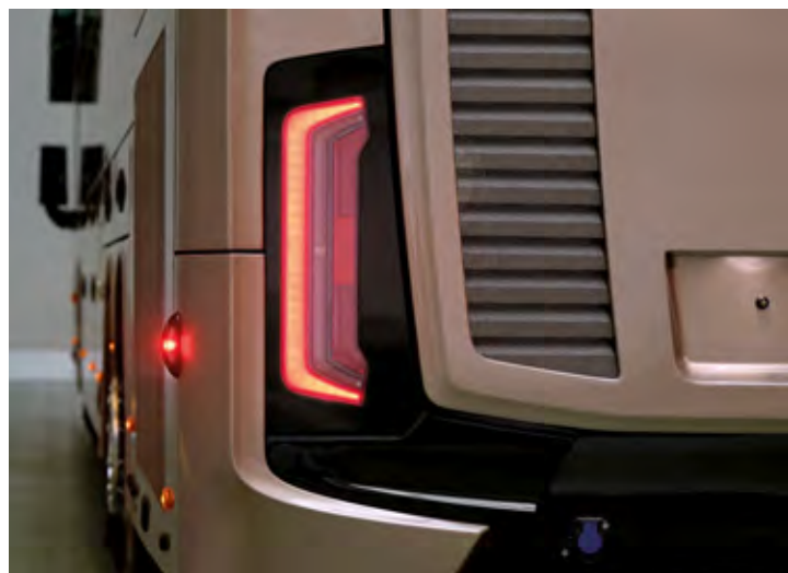
Vse svetila na avtobusu so v celoti LED izvedbe, s čimer se zmanjšuje poraba energije ob istočasno daljši življenjski dobi. Novi žarometi pa avtobusu dajejo tudi prepoznaven oblikovalski pečat.
