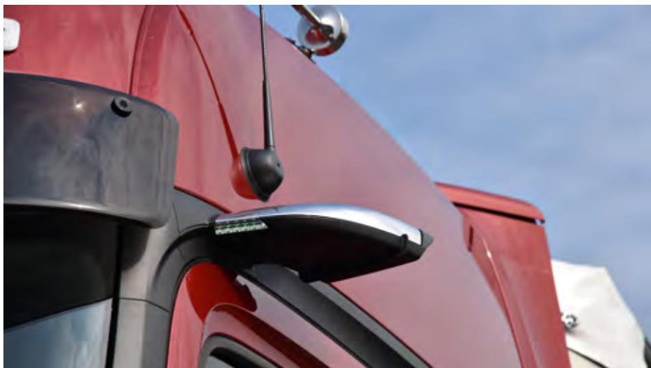
Nosilci kamer sistema MirrorCam so skrajšani za deset centimetrov, zato je perspektiva kamer zdaj bolj podobna perspektivi steklenih vzratnih ogledal.
