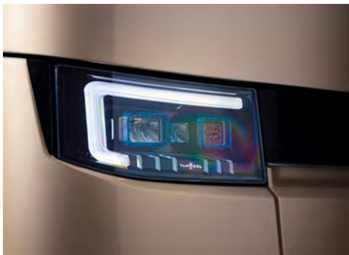
Vse svetila na avtobusu so v celoti LED izvedbe, s čimer se zmanjšuje poraba energije ob istočasno daljši življenjski dobi. Novi žarometi pa avtobusu dajejo tudi prepoznaven oblikovalski pečat.
