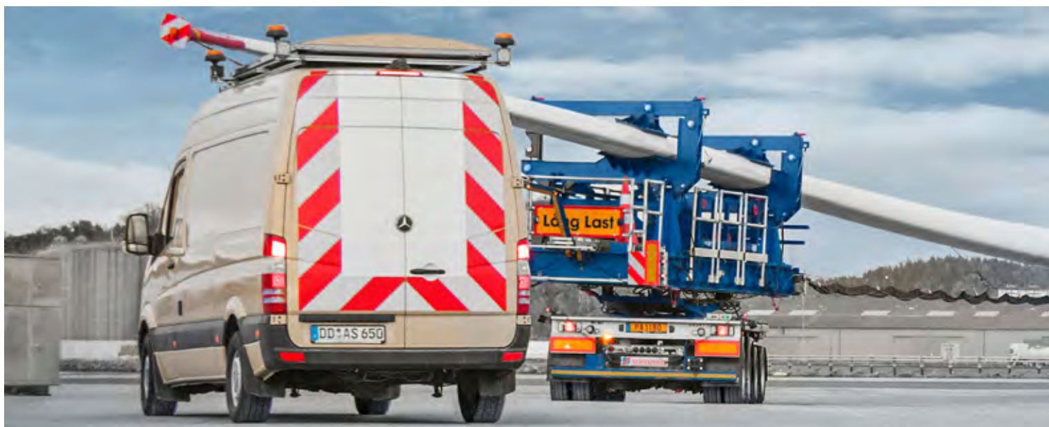
Dvig do višine dveh metrov v napravi za prosto obračanje zadostuje, da je tovar možno varno prepeljati preko površinskih neravnin in
