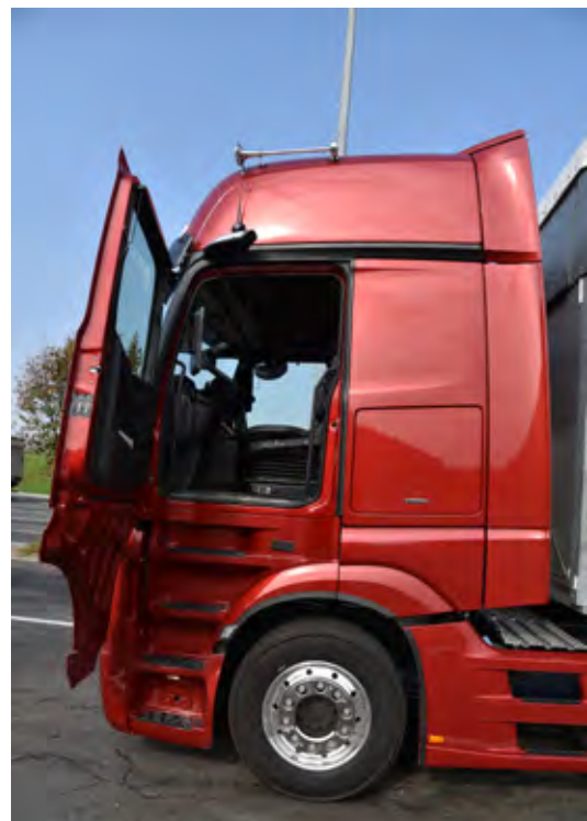
Raven pod v kabini terja svoj davek v obliki četrte vstopne stopnice - vseeno je vstopanje udobno.
