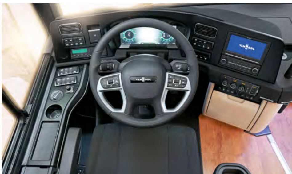
Voznikovo delovno mesto je povsem novo z veliko odlagalnimi predali, novim volanom in osrednjim LCD zaslonom.
