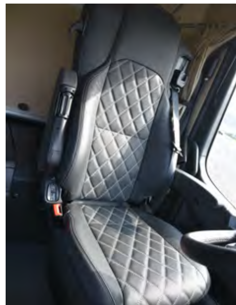
Voznikov sedež je nameščen štiri centimetre nižje in zato nudi več možnosti nastavljanja ter ima bolj kakovostno oblazinjenje, opsijsko pa je na voljo tudi usnjena izvedba.
