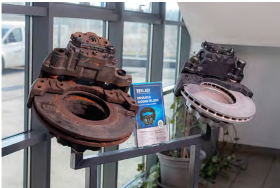
Na zalogi imajo veliko količino tovarniško obnovljenih zavornih čeljusti znamke Teiler z garancijo za vse vrste tovornjakov, avtobusov in prikolic.
