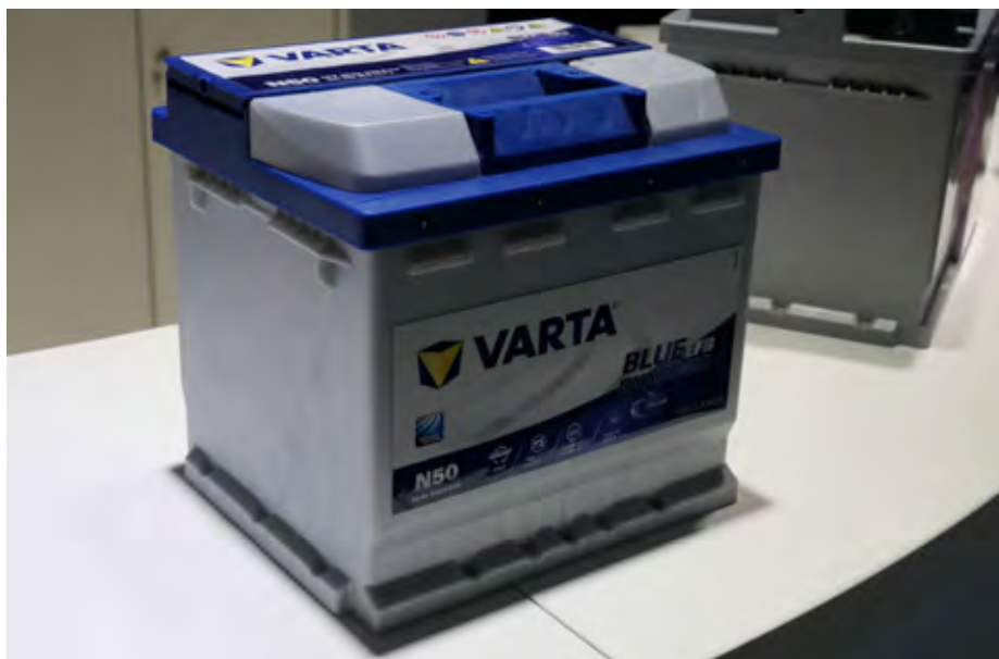
Akumulator EFB je izboljšan akumulator z mokri elektrolitom in je primeren tudi za napajanje preprostejših sistemov start-stop.
