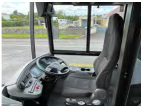
Voznikovo delovno mesto nudi dobro preglednost, armatura je kakovostne izdelave, na voljo pa so tudi odlagalna mesta za drobnarije.
