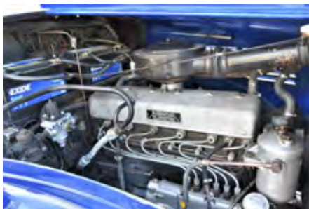
Motor je dobil zgolj nove batne obročke in tesnila.
