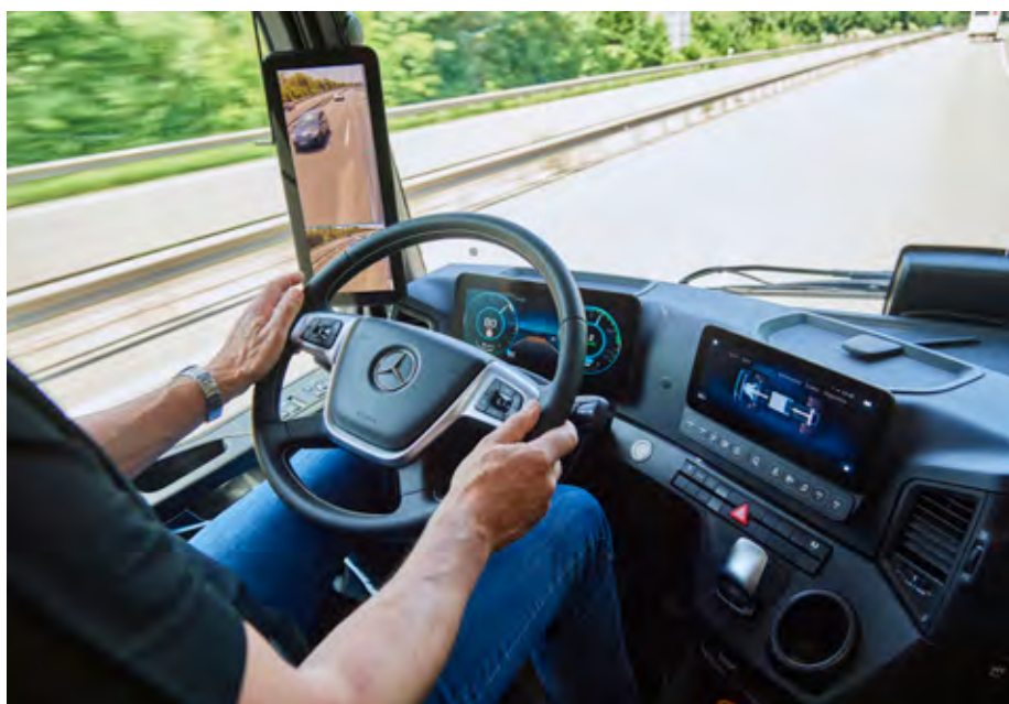
Armatura pri električnem eActrosu je popolnoma identična klasičnemu. Levi zaslon, ki prikazuje sliko kamer, bi si želeli da je nameščen nekoliko višje.
