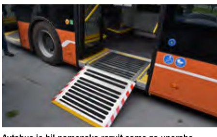
Avtobus je bil namensko razvit samo za uporabo električnega pogona, zato je karoserija nižja kot smo sicer vajeni.
