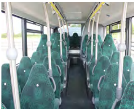
Ker izvira iz dizelske različice so ohranili pokončni motorni prostor v zadku, ki odvzema prostor štirim sedežem.
