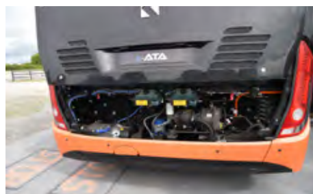
Kljub namenski električni zasnovi, pa baterij niso namestili v pod vozila, s čimer bi zmanjšali težišče.
