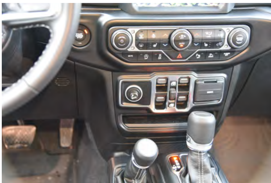
Pod zaslonom se nahaja vrsta gumiranih stikal za upravljanje klimatske naprave, parkirnih senzorjev ostalih sistemov in pod njimi stikala za dvig stranskih stekel.
