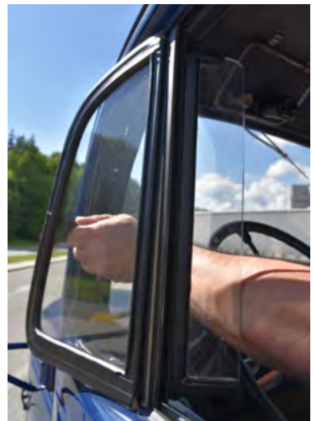
Za zračenje in hlajenje kabine je najpomembnejše trikotno okence, ki se odpre spredaj, piš vetra pa voznik usmerja s steklenim podaljškom na notranji strani.
