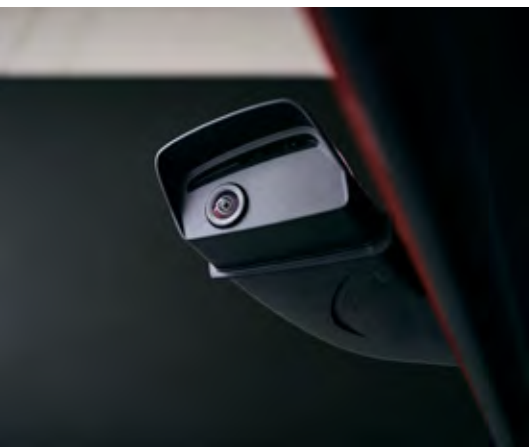
Nosilci so na spodnjem delu opremljeni z robom, ki preprečuje da bi vodne kapljice zašle na lečo.
