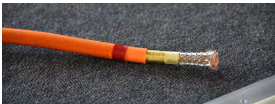
Visokonapetostni 'oranžni' kabli so opremljeni z dvoslojno zaščito in plastjo ki zaznava prerez prvega zaščitnega ovoja ter ob tem samodejno izklopi napajanje.
