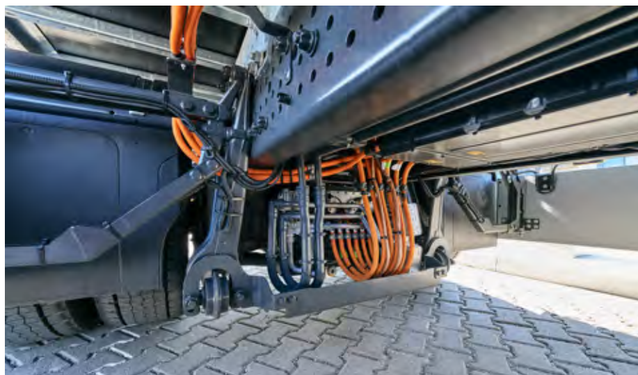
Dva elektromotorja sta nameščena tik ob pogonski osi in z njo direktno povezana z zobniškim prenosom z dvema prenosnima razmerjema - med prvo in drugo prestavo se preklaplja pri hitrosti okoli 30 km/h.
