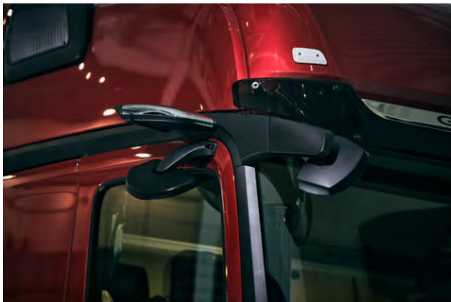
Druga generacija sistema kamer MirrorCam ima za deset centimetrov ožje nosilce, ter izboljšano kakovost prikazane slike na LCD zaslonih v kabini.
