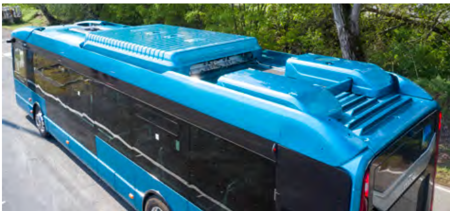
Visokoenergijska LTO baterija hibridnega sklopa se nahaja na strehi za zadnjem delu avtobusa.
