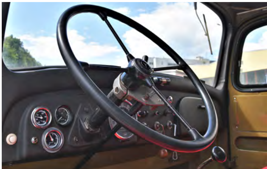
Ob tahografu brez merilnika vrtljajev so v kabini še instrumenta za oljni in zračni tlak ter termometer hladilne tekočine. Voznik ve, da je rezervoar prazen, ko motor sam ugasne.
