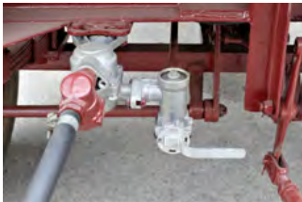
Za zaviranje prikolice je dovolj le ena cev za stisnjen zrak, ventil na desni pa uravnava intenzivnost zaviranja.
