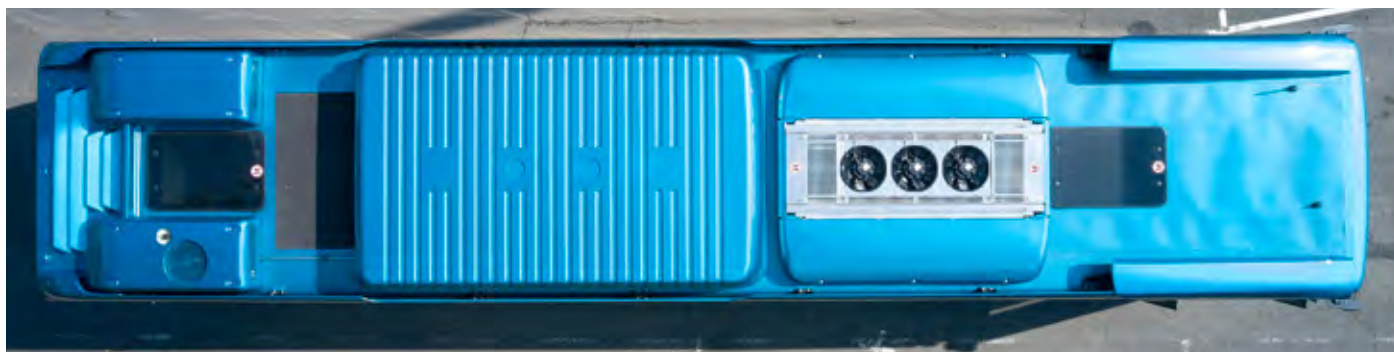
Visokoenergijska LTO baterija hibridnega sklopa se nahaja na strehi za zadnjem delu avtobusa.
