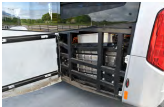
Štirje baterijski paketi so vgrajeni v zadku, a zelo nizko, še dodatnih osem pa je na strehi.
