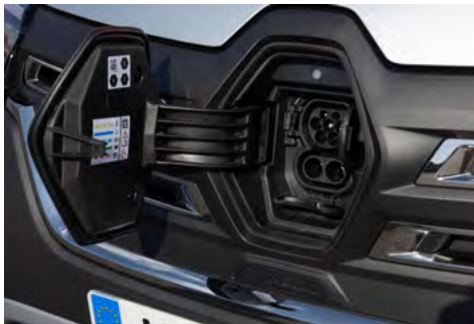
Priključek za polnjenje vozila se nahaja v maski.
