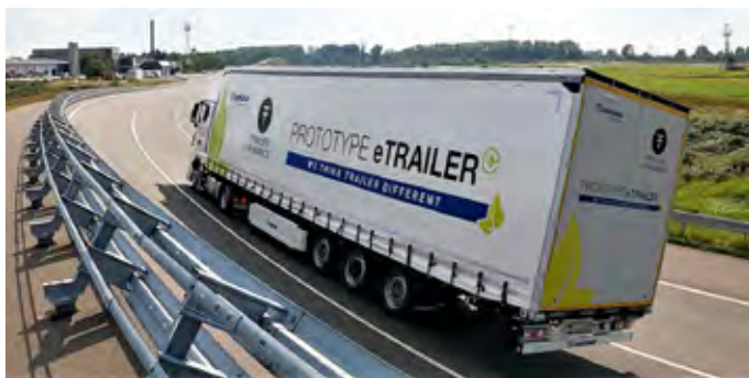
Priklopnik z e-pogonsko osjo pomaga pri vožnji.
