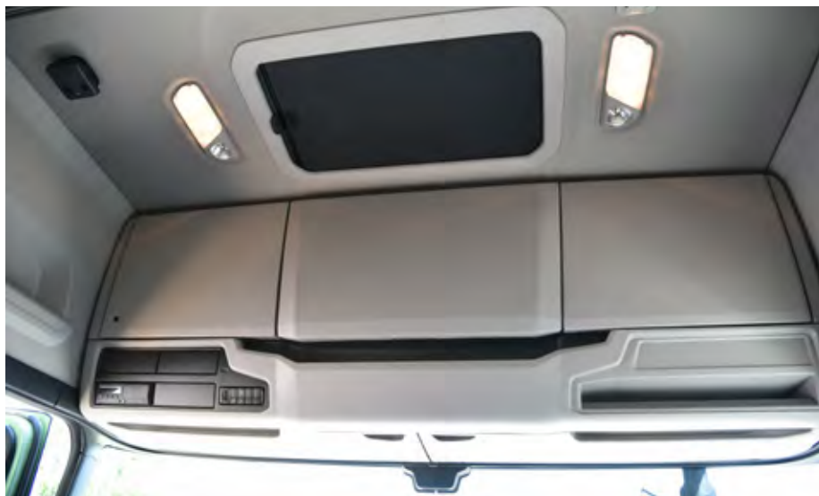
Nad vetrobranskim steklom so nameščene tri velike zaprte shranjevalne omarice.
