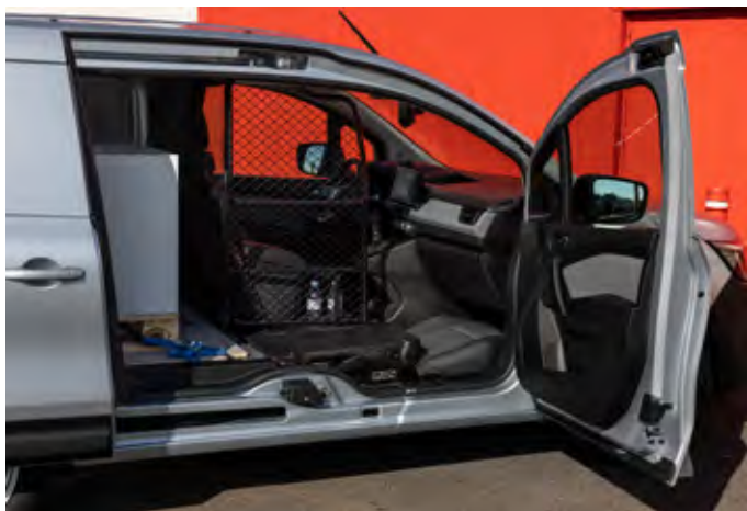
Inovativna zasnova bočnih drsnih vrat 'sezami odpri se' brez vmesnega B stebrička, omogoča odličen dostop do tovornega prostora.
