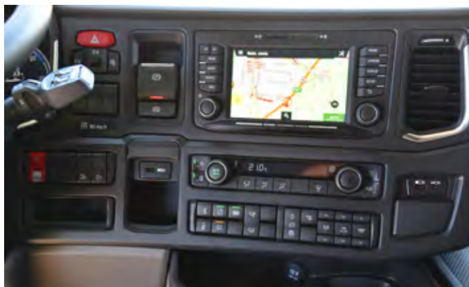
Navigacijska naprava omogoča vnos podatkov o dimenzijah vozila in pot navigira glede na omejitve za tovorna vozila.
