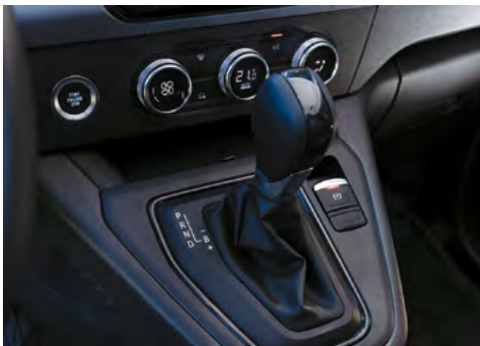
S pomočjo prestavne ročice voznik lahko preklaplja med tremi stopnjami regenerativnega zaviranja.
