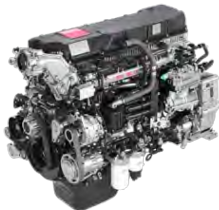
Motor DE11 uporablja tehnologijo valovitih batov za optimizirano zgorevanje, ima nove injektorje goriva ter nov visokozmogljiv turbo polnilnik.
