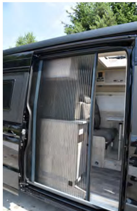
Bočna drsna vrata se odpirajo dvostopenjsko in so opremljena s komarnikom.
