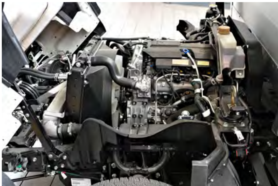
Trilitrski dizelski motor izpolnjuje zahteve Euro 6e in v vseh razmerah zagotavlja dovolj moči. Z dvigom kabine je zlahka dostopen za vzdrževanje in popravila.
