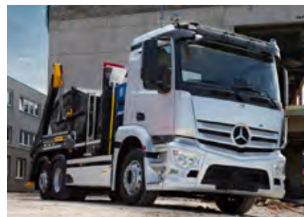
Pri električnem Actrosu bo energija iz pogonskih baterij lahko poganjala tudi hidravlični sistem.
