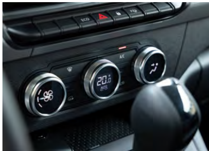
Kangoo E-Tech je, kot edini v svojem razredu, lahko opremljen s toplotno črpalko, ki skrbi za hlajenje in ogrevanje kabine.
