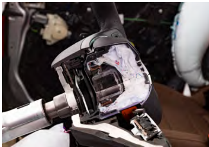
Blazina je v volanskem obroču tesno zložena ob njej pa je tudi pirotehnični prožilni mehanizem.
