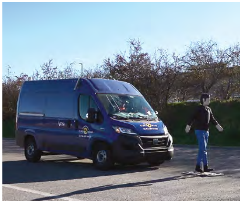
Sodobni sistemi za preprečevanje trka zaznavajo celo pešce in samodejno zavirajo, da jih dostavnik ne bi zadel.
