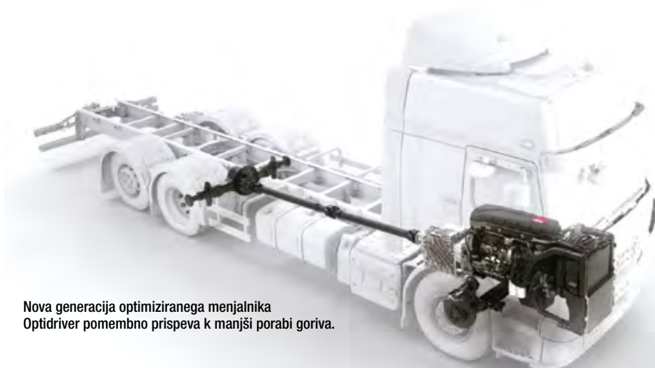
Motor DE11 uporablja tehnologijo valovitih batov za optimizirano zgorevanje, ima nove injektorje goriva ter nov visokozmogljiv turbo polnilnik.
