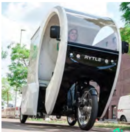
Transportni tricikel je elektrificirano kolo, ki mu pri vožnji pomaga elektromotor.
