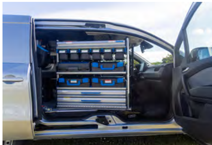
Inovativna zasnova bočnih drsnih vrat 'sezami odpri se' brez vmesnega B stebrička, omogoča odličen dostop do tovornega prostora.
