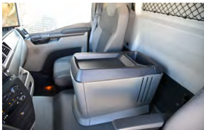
TGL se lahko, kljub nizki namestitvi kabine na šasijo, pohvali z zelo nizkim motornim tunelom.
