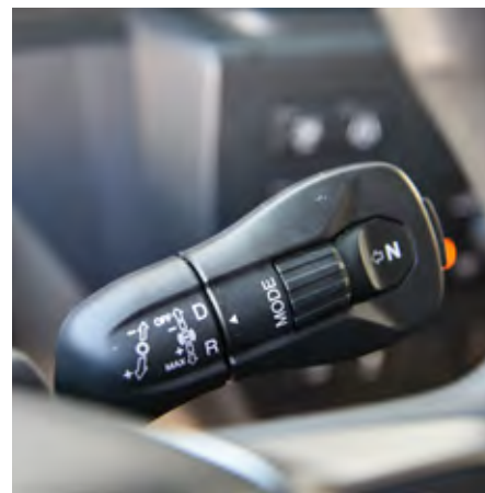
S šeststopenjskim avtomatiziranim menjalnikom voznik upravlja z desno obvolansko ročico.
