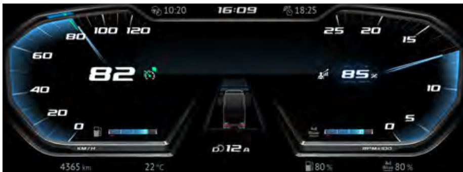
Pregleden osrednji LCD zaslon nadomešča klasične analogne merilnike, njegov prikaz pa si voznik lahko prilagodi svojim željam.
