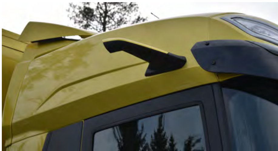
Sistem kamer namesto vzratnih ogledal, skupaj z ostalimi aerodinamičnimi izboljšavami kabine, prispeva k kar 19 odstotkov boljši aerodinamiki.
