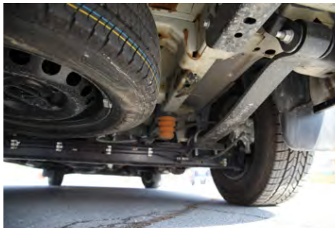
Rezervna pnevmatika je nameščena na dnu vozila.
