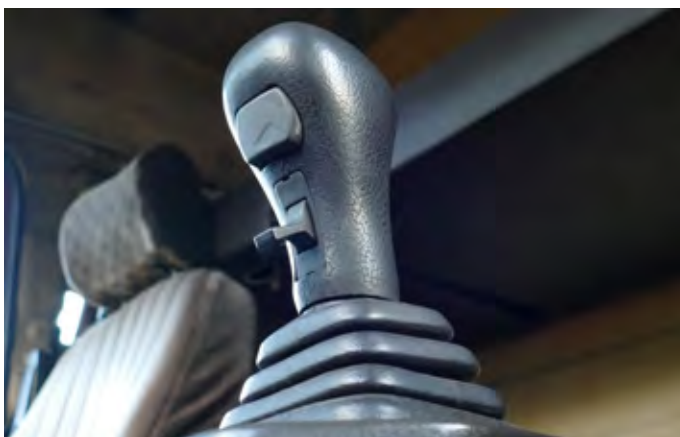
Ročica menjalnika se premika samo naprej in nazaj ter levo (za prosti tek). Zgornji gumb je za vključevanje vzratne prestave in za preskakovanje prestav, spodnji pa za polovičke.
