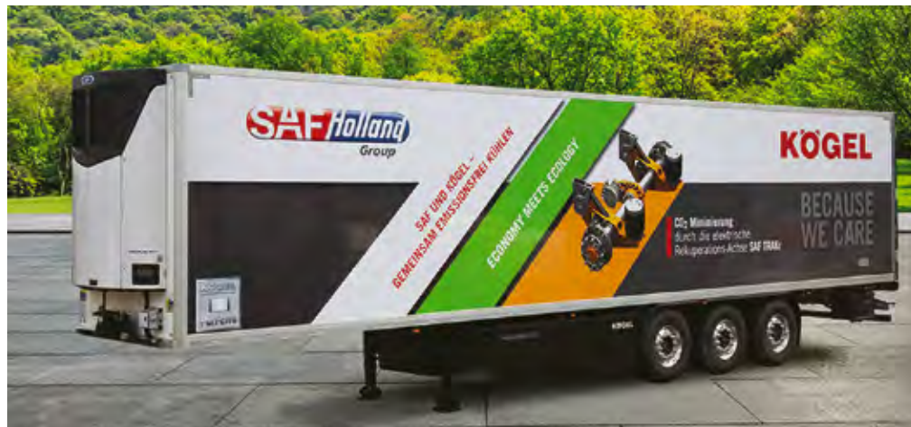
S pomočjo rekuperacije kinetične energije nastaja elektrika, ki poganja hladilni agregat, brez potrebe po fosilnih gorivih.
