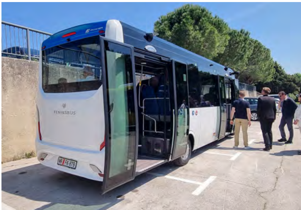
Prenovljen zadnji del avtobusov ima sodoben izgled, z vsemi svetili LED izvedbe. Električno gnan model ePower ponuja do 250 kilometrov dosega in lahko sprejme do 33 potnikov.
