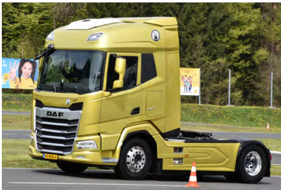
DAF je prvi evropskih proizvajalec tovornjakov, ki v celoti izkorišča nove evropske predpise glede večje dovoljene dolžine, kar se odraža na boljši aerodinamiki, večji varnosti in prostornosti.
