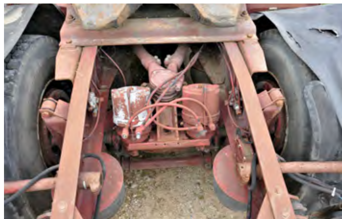
Zadnjo premo podpirajo štiri zračne vzmeti, za njeno vodenje in stabilnost z zgornje strani skrbi »zajec«, s spodnje pa močan prečni stabilizator.
