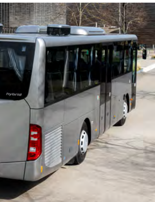
Superkondenzatorji, v katerih se hrani električna energija, so nameščeni na strehi, na zadnjem delu avtobusa.
