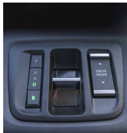
Električni Berlingo ponuja tri osnovne programe in dodatnega B za povečano regenerativno zaviranje.
