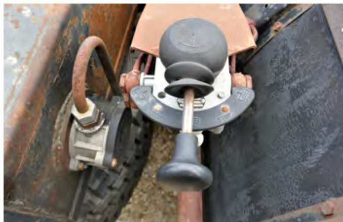
Na levi strani je pred pogonsko osjo ročica, s katero dvignemo ali spustimo zadnji del šasije.
