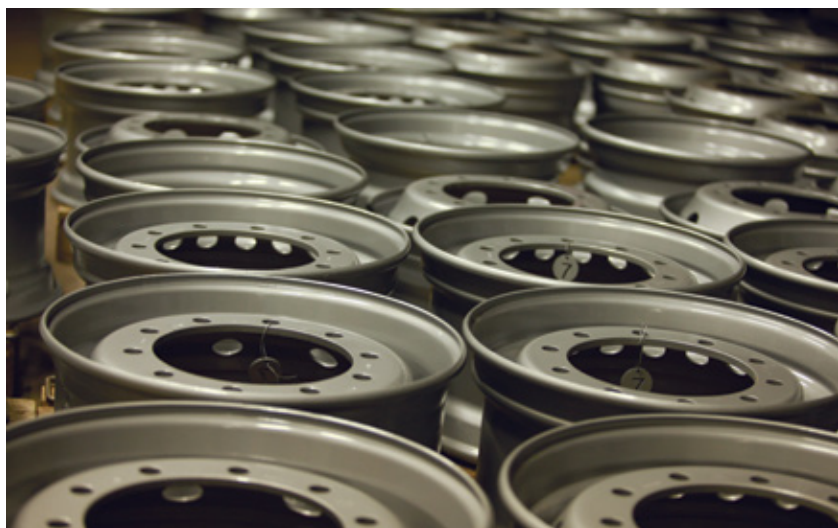
Sušenje poteka en dan. S tem podjetje zagotavlja, da je proces kvaliteto zaključen in pri montaži ne bodo nastale mehanske poškodbe, ki bi lahko povzročile predčasno rjavenje.
