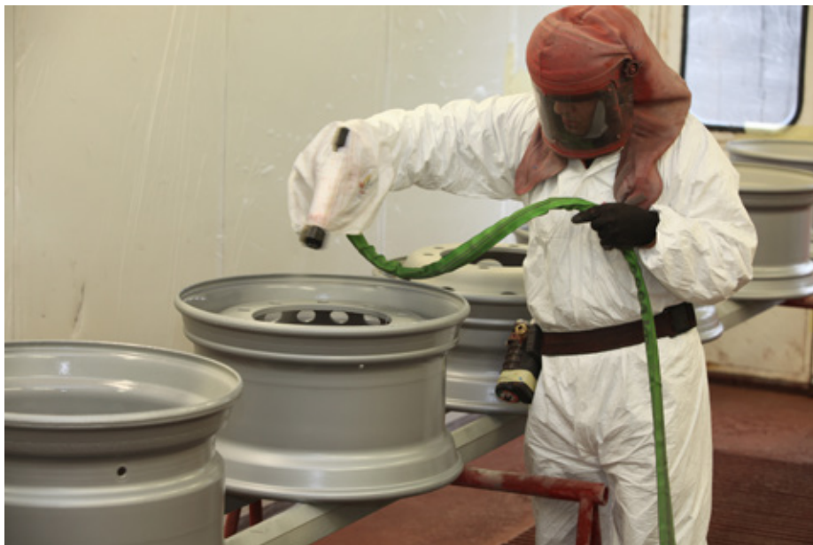
Lakiranje z dvokomponentnimi barvami poteka v dveh fazah: lakiranje s temeljno barvo in lakiranje s prekrivno barvo. Temeljna je protikorozijska barva, pokrivna barva pa nudi zaščito pred UV in mehanskimi udarci ter daje lesk.
