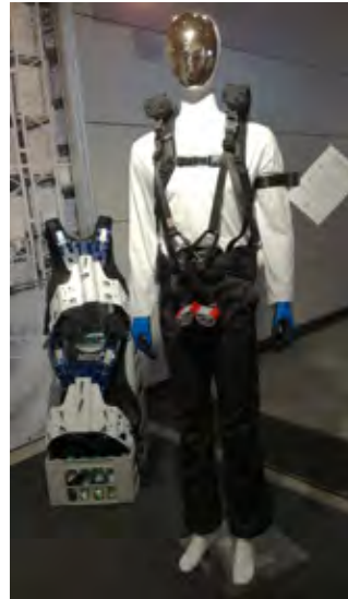
Ergonomski zunanji skelet za razbremenitev in preprečevanje poškodb hrbtenice
