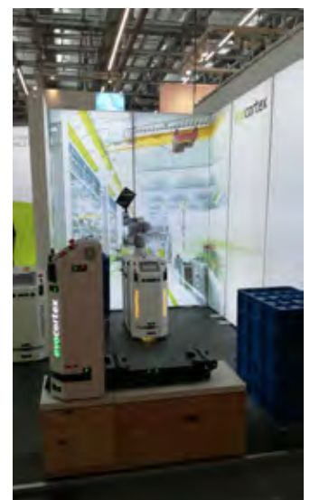
»AGV« majhnih dimenzij (levo) in kolaborativni robot v sodelovanju z AGV (desno)
