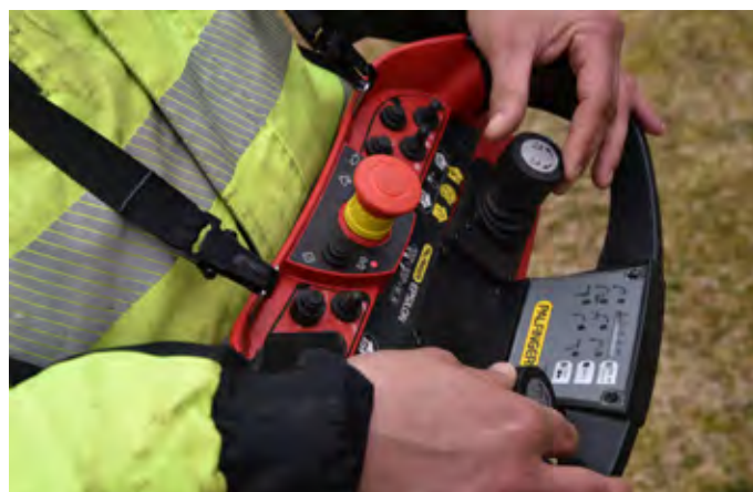
Prenosni daljinski upravljalca olajša natančno delo s hidravlično roko.
