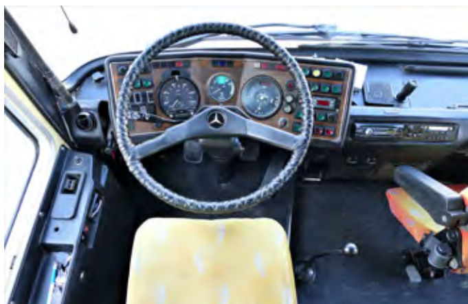
Vozniški delovni prostor je v duhu časa, ko so avtobus izdelali, na desni je dolga prestavna ročica, levo od volana pa vzvod za ročno zavoro, ki so ga teden po našem obisku zamenjali.
