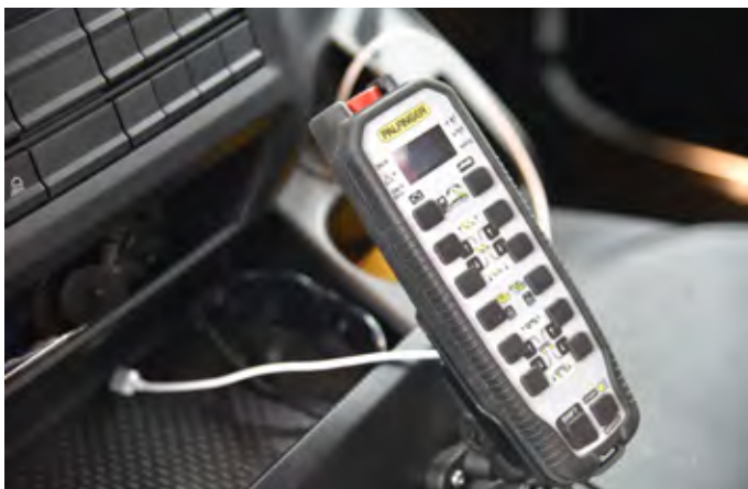
Nadgradnja se upravlja s pomočjo daljinskega upravljalnika, ki je sicer nameščen v kabini.
