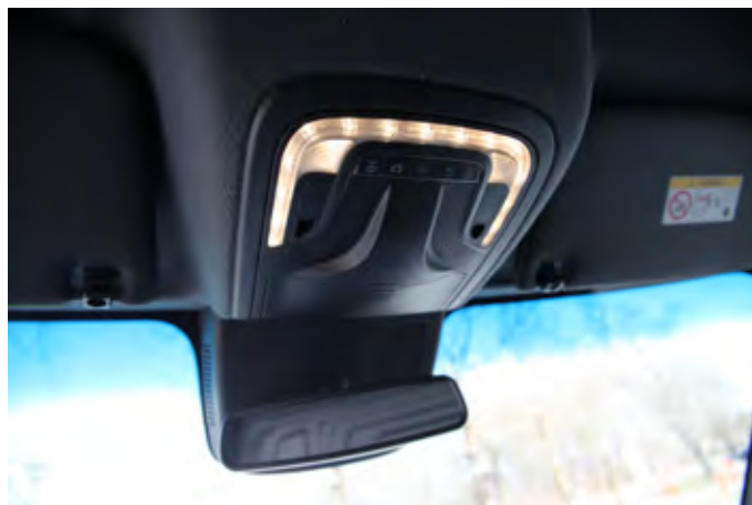
Tako kabinski, kot tudi tovorni del, sta osvetljena z LED svetili.
