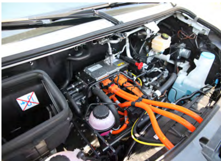
eSprinterja poganja 86 kW/116 KM električni motor.
