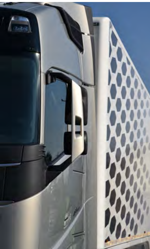
Nosilci vzvratnih ogledal so aerodinamično izboljšani, v desnem je lahko vgrajena tudi kamera.
