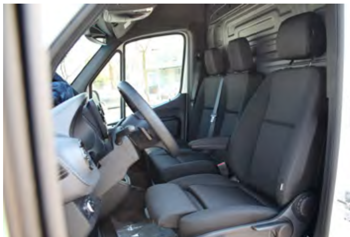
Voznikov komfortni sedež je mogoče prilagoditi v vzdolžnem položaju, višini, naklonu in globini sedežne blazine.
