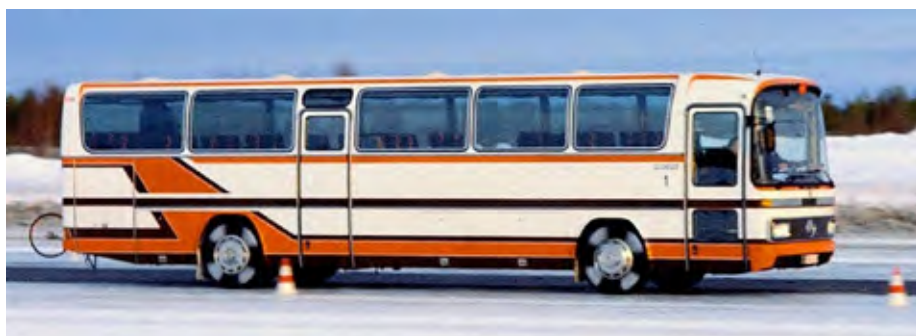
Mercedes-Benzov O 303 je bil prvi avtobus s sistemom proti blokiranju koles (ABS).
