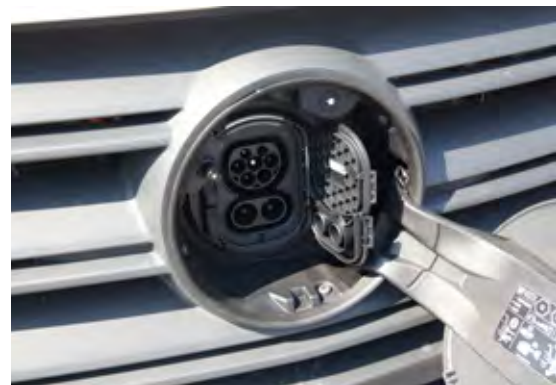
Polnjenje z enosmernim tokom od 10-80 % kapacitete baterije z vgrajenim standardnim 20 kW polnilnikom traja 120 minut.
