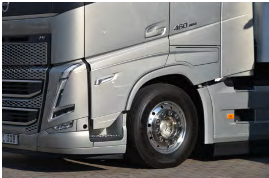
Drobni detajli, kot je podaljšek na vratih, zmanjšujejo vrtnčenje zraka in posledično zračni upor vozila, kar vse prispevka k manjši porabi goriva.
