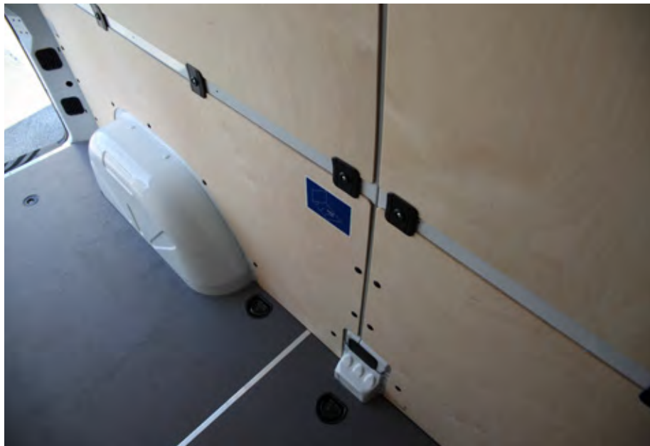
Pritrdilna mesta lahko obremenite z do 5 kN obremenitve.
