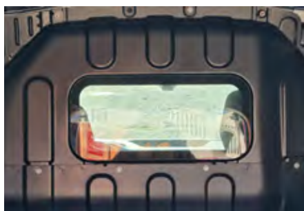
Serijsko je vozilo opremljeno s kovinsko pregrado, ki loči tovorni del, izberete pa lahko tudi zložljivo mrežasto predelno steno s premičnim desnim delom za prevažanje daljših bremen.
