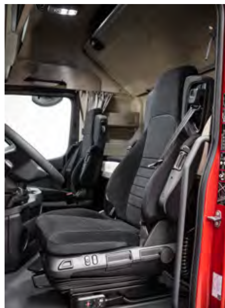
Voznikov sedež je nameščen nižje in zato omogoča večji razpon nastavitvev.
