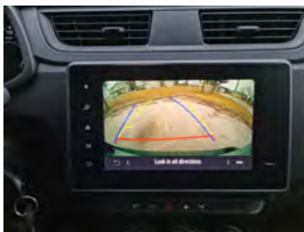
Kamera za vzvratno vožnjo sliko prikazuje na osrednjem multimedijem zaslonu.
