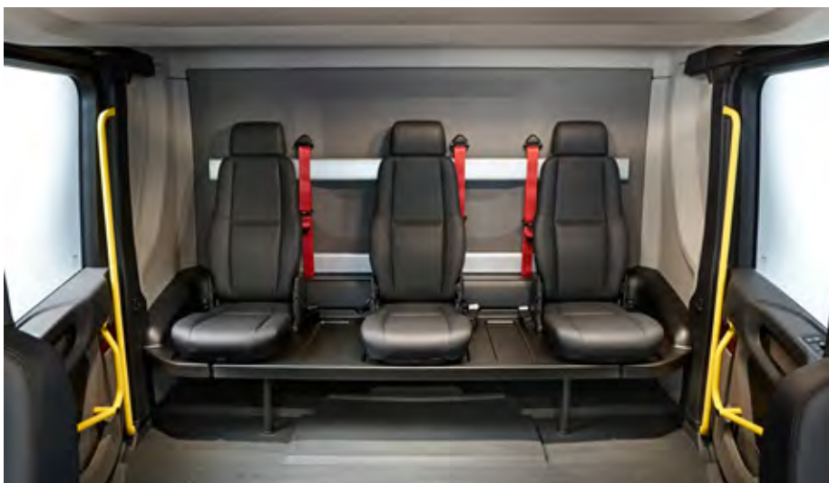
Podaljšane kabine za prevoz posadke se najbolj pogosto uporabljajo za gasilska vozila.
