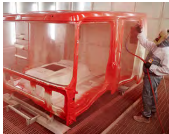
Proizvodnja Scaniinih specialnih kabin se v celoti izvaja v tovarni v Laxi.
