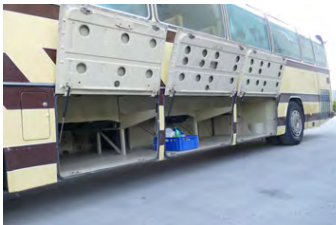
Prostor za prtljago je bogato odmerjen, njegovi aluminijasti pokrovi pa prispevajo k manjši teži vozila.
