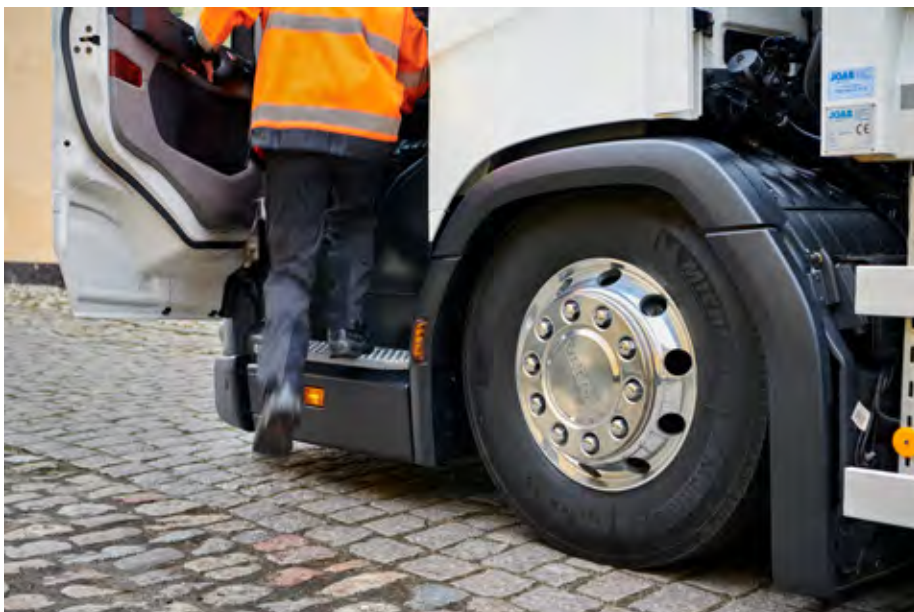
Nizkopodna zasnova kabin olajša pogosto vstopanje in izstopanje in je zato idealna za komunalna in distribucijska vozila.
