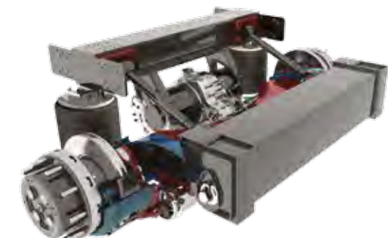
Za pogon prikolice skrbi električna pogonska os.
