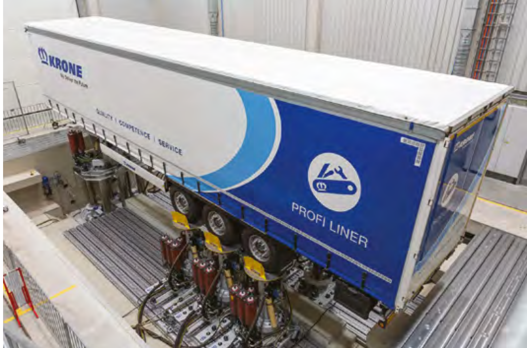
V novem testnem centru je tudi objekt za preizkušanje prikolic pod najtežjimi obremenitvami.
