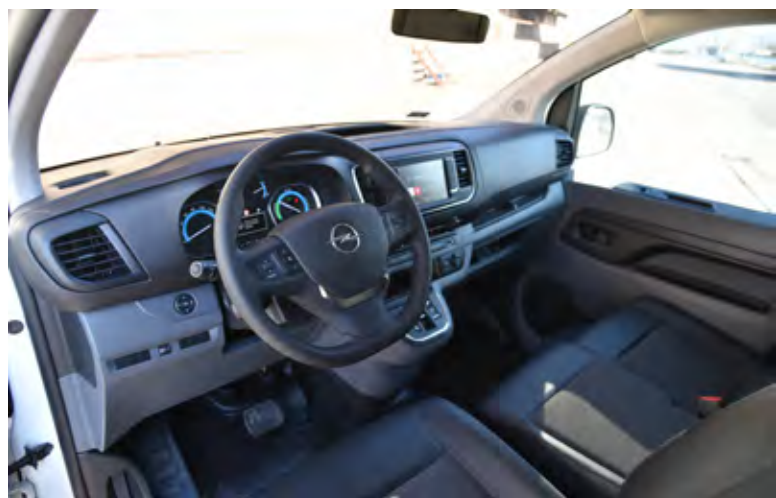
Kabina je takšna kot v dizelskih različicah, s prirejenimi instrumenti, sopotniška klop je spodaj deljena.
