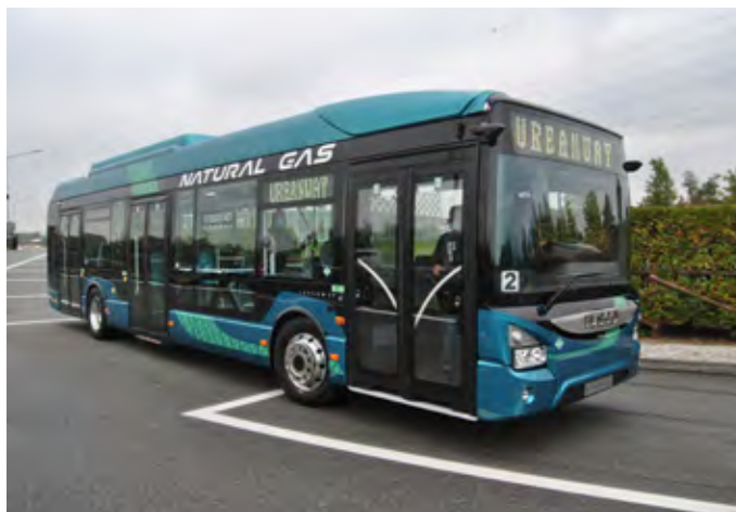
Spremenjen način vgradnje motorja je pri Urbanwayu poskrbel za povsem nov zadek, avtobus pa je postal tudi lažji.
