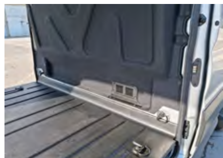
V tovornem prostoru je deset zelo močnih ušes za pritrdjevanje tovora, tako da voznik trak napne brez strahu.
