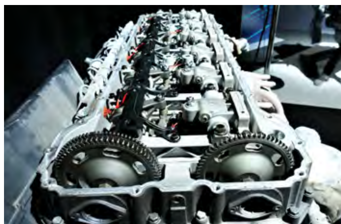
Najbolj očitni in vidni spremembi sta enotna glava za vseh šest valjev in v njej nameščena dvojna odmična gred. Tam je tudi mehanizem za CRB, ki tehta le 7 kg.
