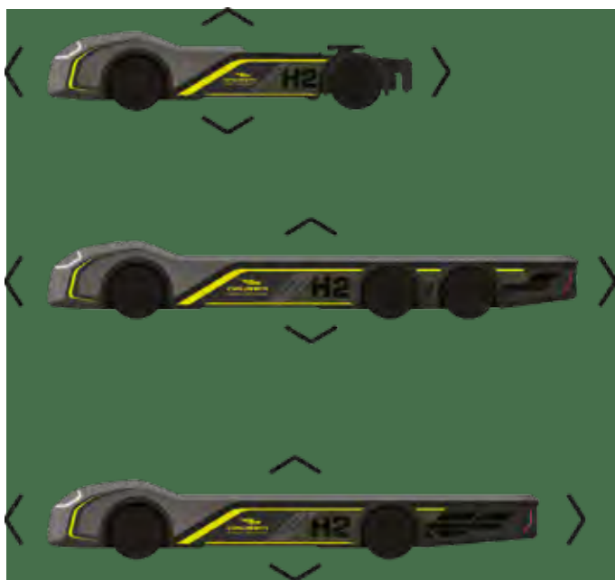
Modularna zgradba šasije omogoča, da je osnova pri vseh modelih enaka in se prilagaja različnim izvedbam.
