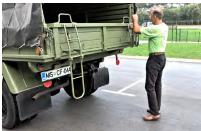
Tovorni zaboj ima novo dno, lestvi oziroma stopnici na obeh straneh pa sta izvirni.
