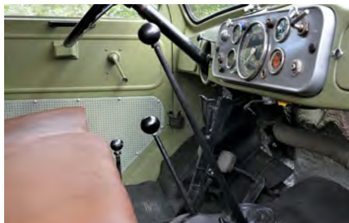
Po velikosti: največja ročica je prestavna, nato pod enakim kotom sledi ročica vitla, tik ob sedežu je ročica za vključevanje diferencialne zapore. Najmanjša (ob ročni zavori) pa ukazuje reduktorju.
