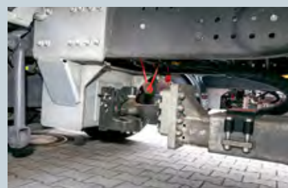
Sistem priklopa Rockinger RO-KU 80 je optimiziran za transport vozil.
