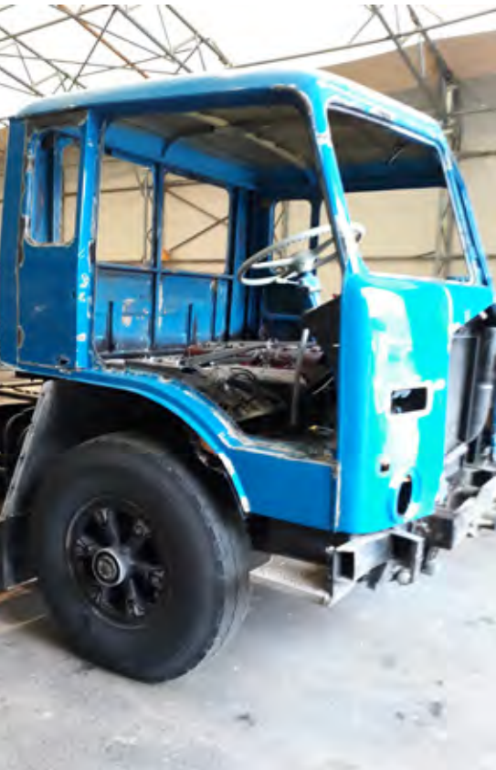
Kabina je dobila nekaj novih pločevinastih zaplat, za oblazljenje pa je poskrbel izkušen tapetnik.
