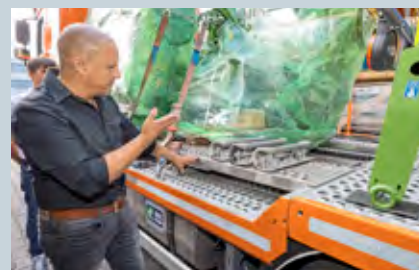
Prečno drsne rampe se lahko prilagodijo različnim širinam kolotekov.
