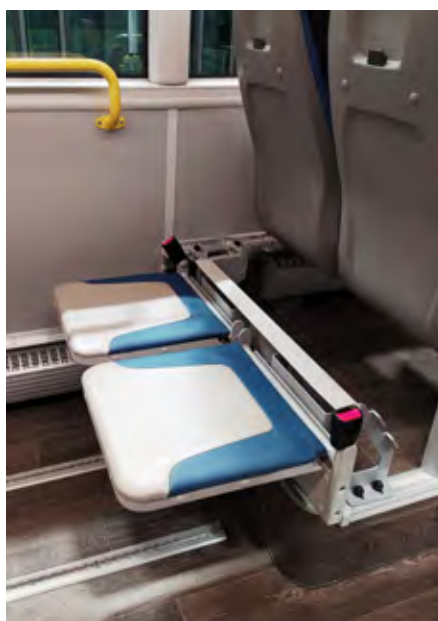
Pomožni zložljivi sedeži so nameščeni v prostoru, ki je predviden za namestitvev otroških ali invalidskih vozičkov.
