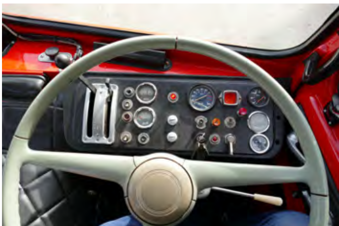
Armatura plošča ima kar nekaj uric za temperaturo in različne tlake. Zaman iščete merilec vrtljajev, za pretikanje se mora voznik zanašati na posluh.
