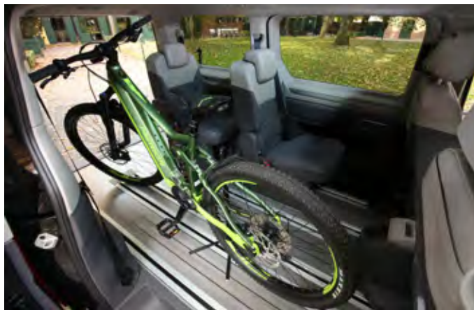
Tirni sistem omogoča, da se lahko srednja in zadnja vrsta sedežev premikata naprej in nazaj ali obračata za 180 stopinj neodvisno drug od druge. Izgradnja sedežev je izredno enostavna.
