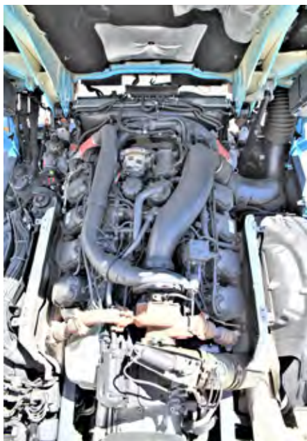
Pri Scanii je še vedno mogoče naročiti osemvaljni motor z močmi 590 do 770 KM (434 do 566 kW)
