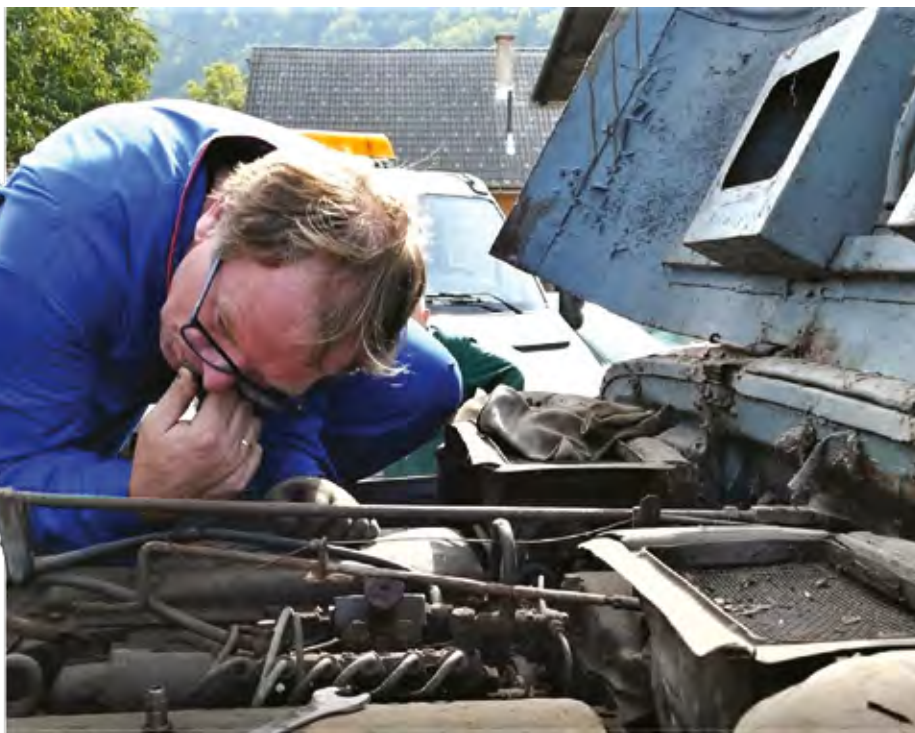
Simon je brez oklevanja potegnil dizelsko gorivo iz dovodne cevi za črpalko.
