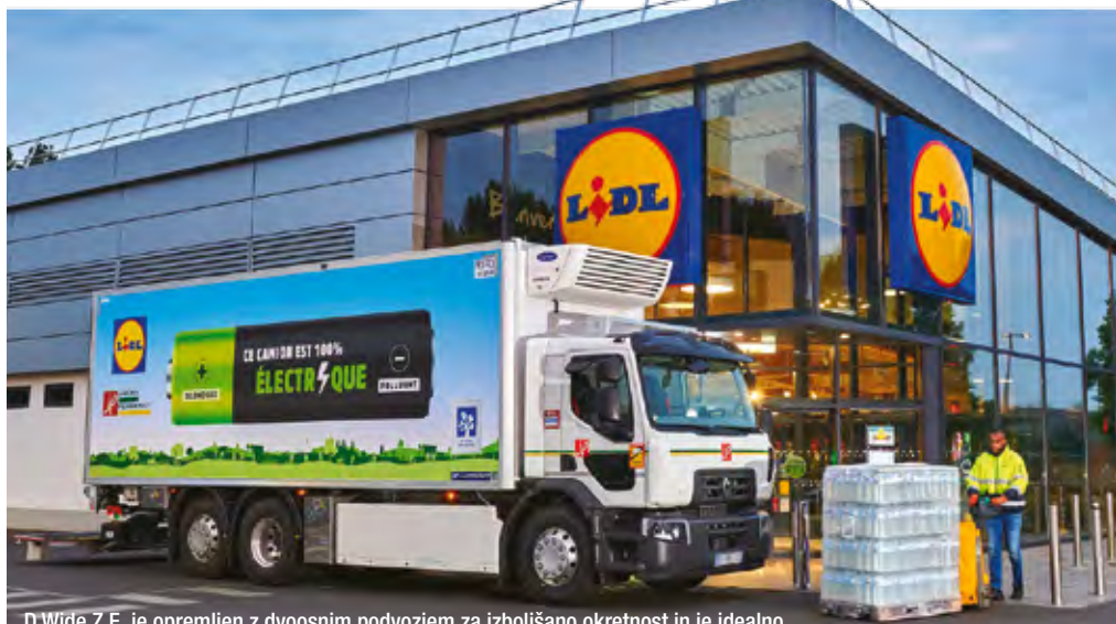
D Wide Z.E. je opremljen z dvoosnim podvozjem za izboljšano okretnost in je idealno vozilo za temperaturno regulirano distribucijo z optimizirano nosilnostjo.
