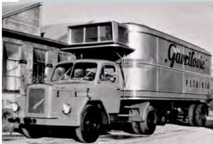
Sprva so za vleko polpriklonnikov služili TAM-i s štirivaljnimi motorji (4500 in 5000), potem pa so jih večinoma zamenjali s šestvaljnimi 5500 ter 6500.
