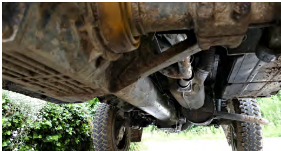
Glavni del šasije je močna jeklena cev (backbone chassis) z integriranima diferencialoma.
