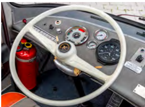
S 9 ima 37 + 2 sedežev, močnejši motor Henschel 522 DPK (prostornina 6.130 cm 3 ) in 92 kW (125 KM). Mere (D x Š x V): 9.630 x 2.500 x 3.150 mm
