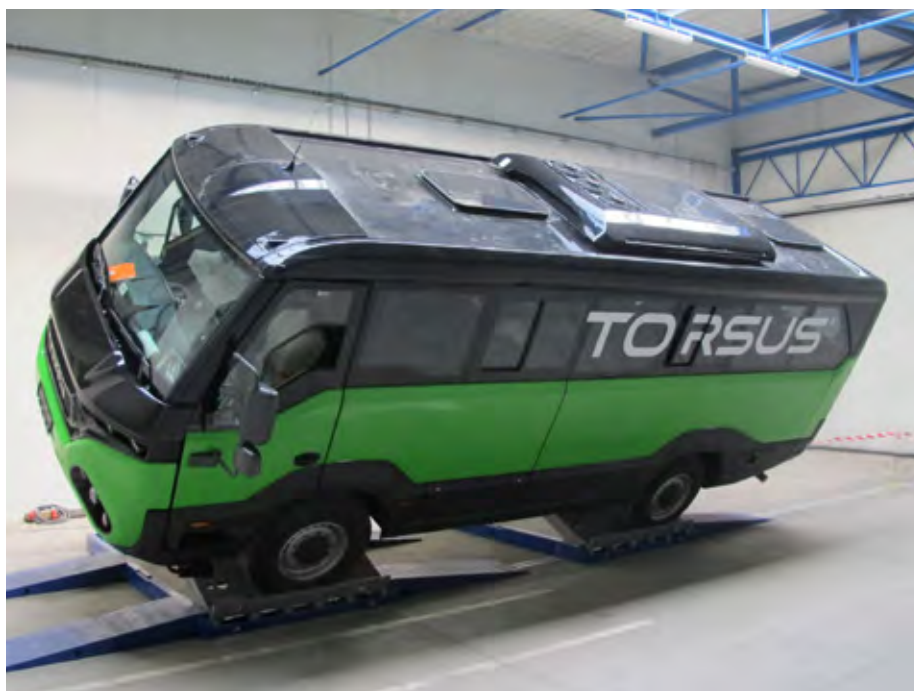
Vozilo ostane stabilno tudi pri 33-odstotnem naklonu.
