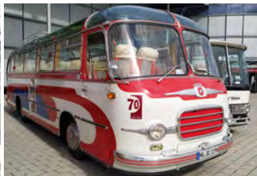
S 9 ima 37 + 2 sedežev, močnejši motor Henschel 522 DPK (prostornina 6.130 cm 3 ) in 92 kW (125 KM). Mere (D x Š x V): 9.630 x 2.500 x 3.150 mm
