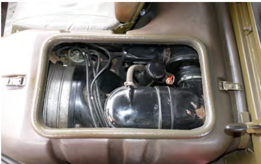
Motor je zaradi nižjega težišča ležeč (glave so obrnjene proti vozniku), »skrit« pod pokrovom med prednjima sedežema, manjši pokrov je tam zaradi lažjega preverjanja količine olja in njegovega dolivanja.
