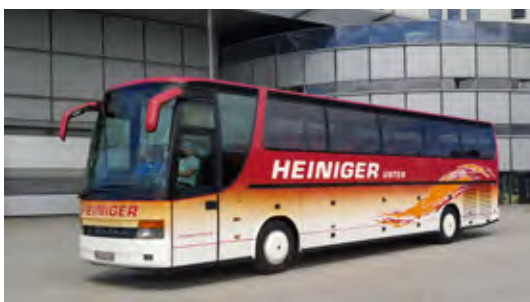
Setra S 315 HDH/2 je bila proizvedena leta 1976. Ima vgrajen 8-valjni Mercedesov motor OM 442 LA, prostornine 14.618 cm 3 z zavirljivo močjo 324 kW (440 KM). Nameščen je 8-stopenjski ročni menjalnik ZF 8 S 180, avtobus pa sprejme do 46 + 2 potnikov.
