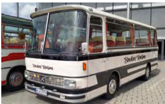
Manjši model S 80 iz leta 1975 lahko prevaža 28 + 2 osebi. Ima močnejši motor Henschel 522 s prostornino 6.788 cm 3 in 107 kW (145 KM). Mere (D x Š x V): 7.720 x 2.300 x 2.870 mm.
