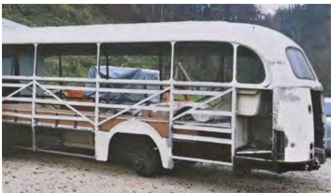
O 321 je bil prvi Mercedesov avtobus s samonosno karoserijo in motorjem zadaj –takole je bil videti Bizjakov, ko so ga »slekli«.
