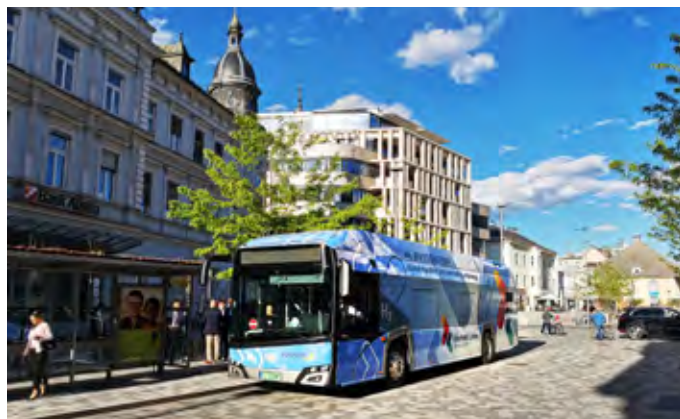
Solaris Urbino 12 Hydrogen tehta 19,2 tone, lahko sprejme do 37 potnikov na sedežih in skupno največ 89. Električna energija, ki nastane s procesom kemične reakcije, se prenese na pogonsko gred ZF AV 130, v kateri sta 2 elektromotorja s 125 kW moči.
