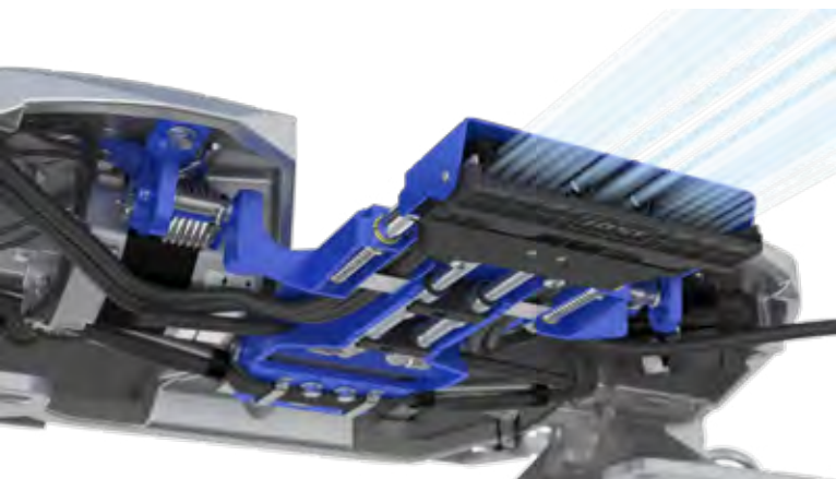
ISO-certificiran KKS priklop, preko katerega potekajo vse povezave vlečnega vozila s polpriklopnikom.
