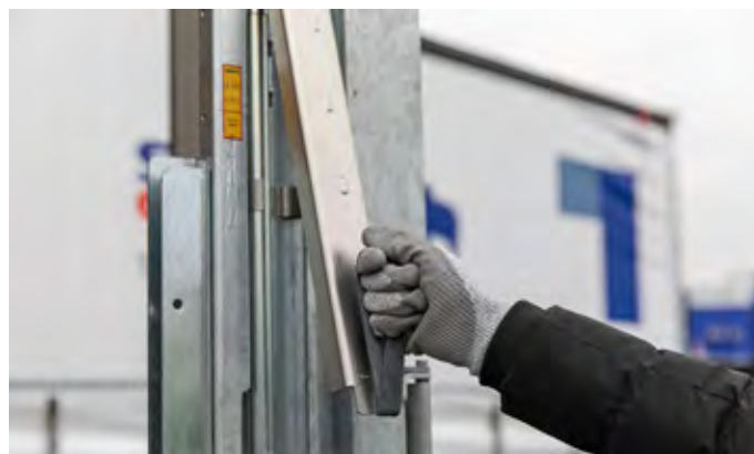
Streha se dvigne ročno z uporabo hidropnevmatske črpalke, medtem ko se višina nastavlja s pomočjo stebrov.
