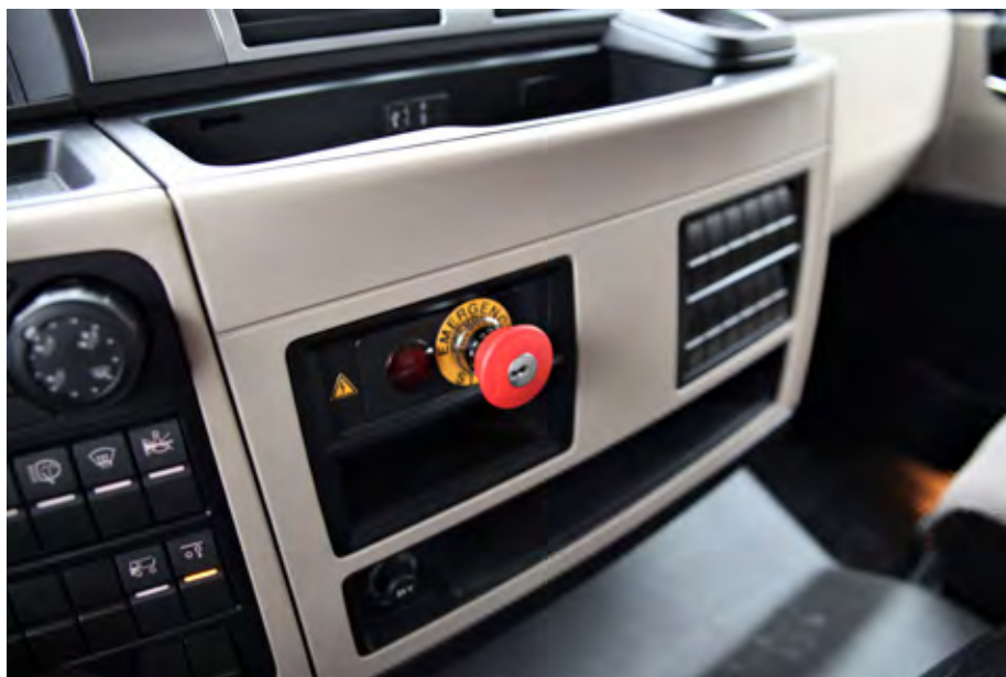
Od dizelskih modelov se loči tudi po stikalu, s katerim lahko ob nesreči popolnoma prekinemo električni tok.
