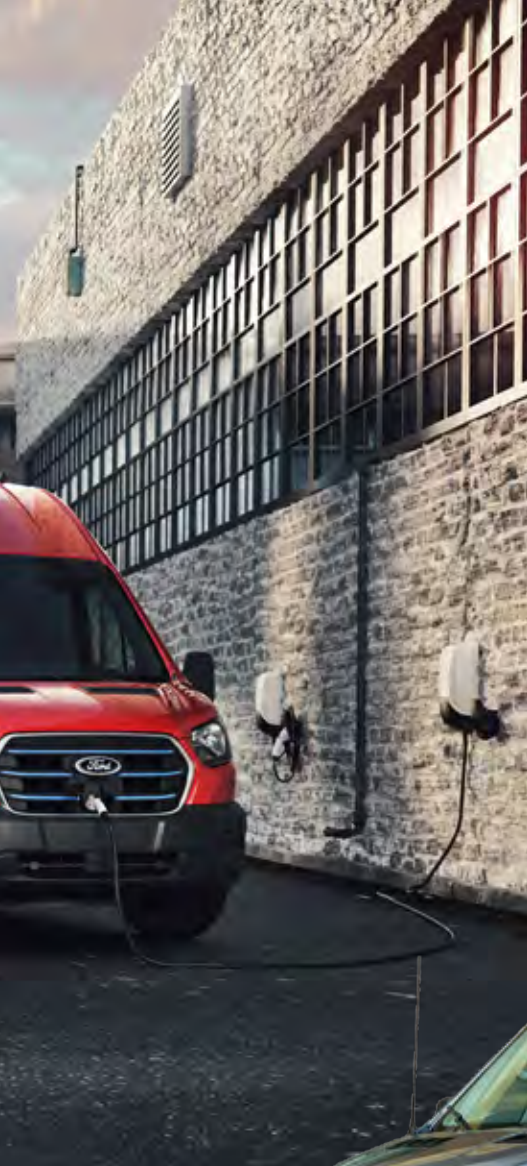
Enosmerni hitri polnilnik omogoča polnjenje do moči 115 kW. Z njim je možno v približno 34 minutah napolniti baterijo s 15 na 80 odstotkov.
