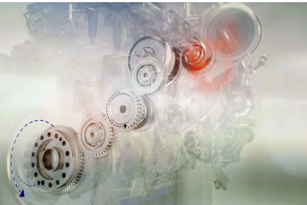
Izpušni plini vrtijo turbino sistema Turbo Compound, ki pomaga vrteti motorno glavno gred – povezava ni toga, saj so v nizu zobnikov vgradili viskozno sklopko.
