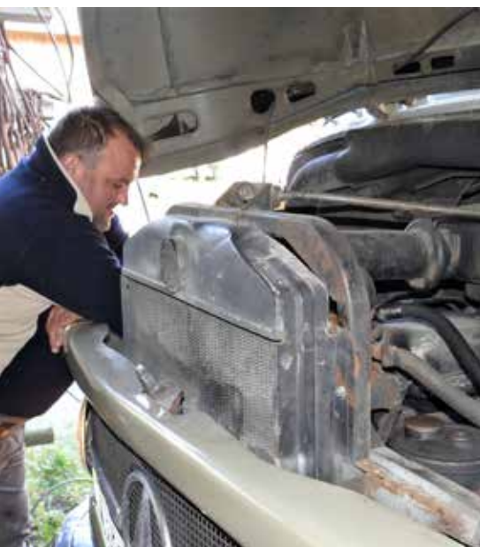
Tomaž meni, da pri motorju ne bo potrebno več kot servis naftne črpalke in nastavitve ali obnova šob.
