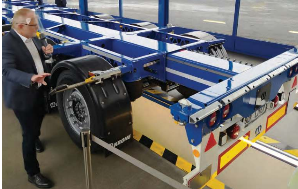
Kontejnerska šasija nove generacije za Box Liner ima možnost podaljšanja zadka, kar zmanjša obremenitev sedla.
