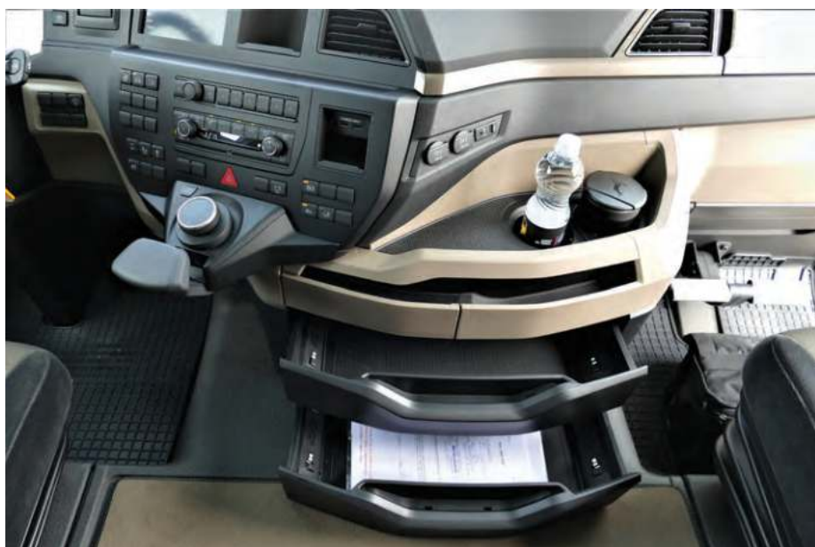
Sredi kabine so trije predali, na armaturi je poleg tega veliko prostora za odlaganje drobnarij.
