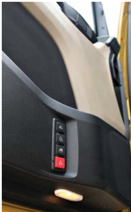
Stikala na spodnjem robu vrat poskrbijo, da se ni treba za vsako malenkost vzpenjati v kabino.
