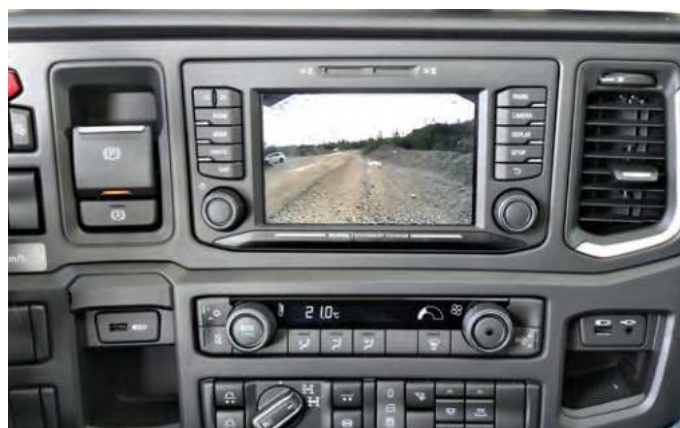
Desno od volana je zgoraj »infotainment«, pod njim so tipke klimatske naprave, čisto spodaj del za upravljanje pogona na terenu.
