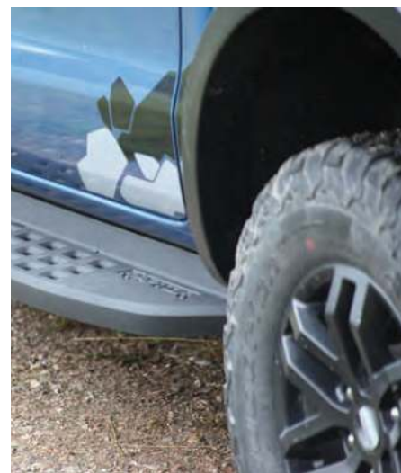
Masivni in trpežni stranski pragovi obenem nudijo zaščito in omogočijo lažji vstop v vozilo.
