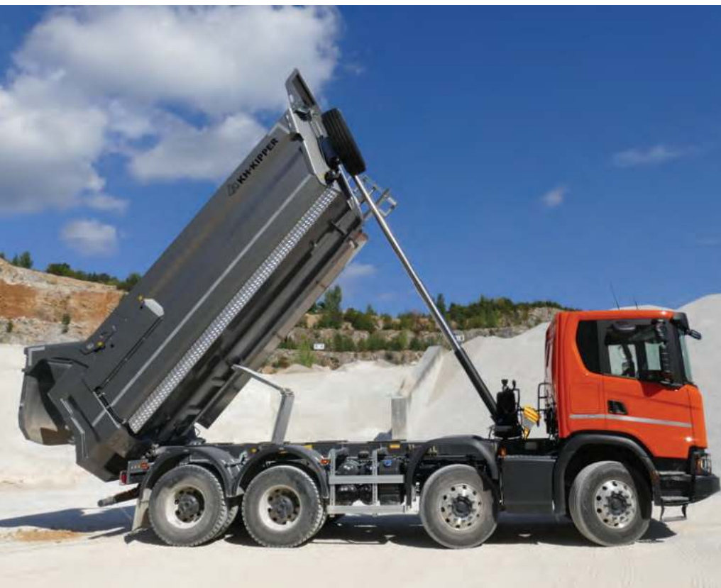
Enostranski prekucnik ima zgolj eden teleskopski hidravlični valj (svečo) in prečni stabilizator (škarje) za boljšo stabilnost ter večjo vzvojno trdnost.
