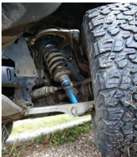
Blažilniki Fox Pro popolnoma spremenijo naravo vozila, ki je sedaj postalo udobnejše, obenem pa tudi pripravljeno na najtežje naloge - tudi skoke.
