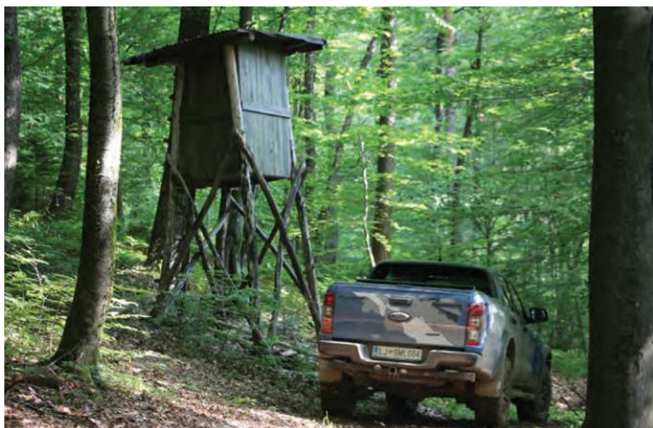
Tovorna obremenitev znaša 680 kg, vlečna zmogljivost pa 2.500 kg.
