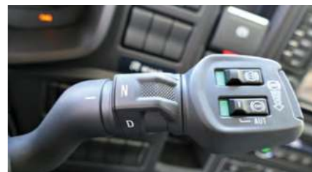
Z desno obvolansko ročico izbiramo ali bomo peljali naprej ali nazaj, zaviramo z retarderjem in motorno zavoro, ročno pretikamo ...
