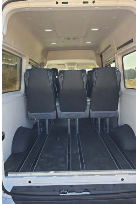
Šest izmed sedežev je samostojnih – nameščeni so na vodilih, ki omogočajo premikanje naprej in nazaj in s tem prilagajanje volumna prtljažnega prostora.
