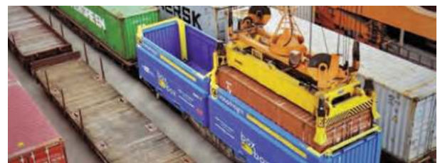
Prikaz vstavljanja 20' kontejnerja v ogrodje, ki je namenjeno prevozu razsutega tovora (Luški glasnik 6/2020).
