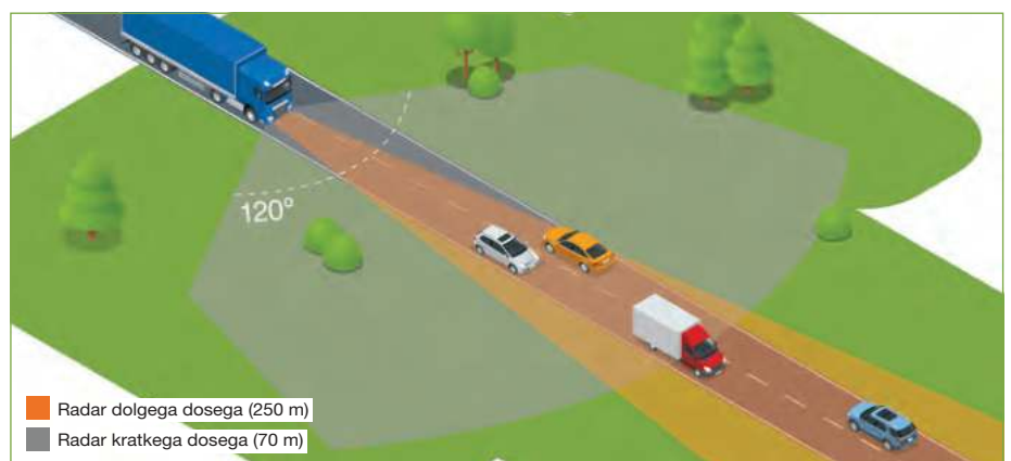
Visokonačan dvojni radar s 16 antenami (prej: 7) za zaznavanje daljnega in bližnjega dosega. Senzor dolgega dosega se lahko pohvali z najdaljšim dosegom v industriji, in sicer zaznava ovire v oddaljenosti do 250 metrov (prej: 200 metrov).
