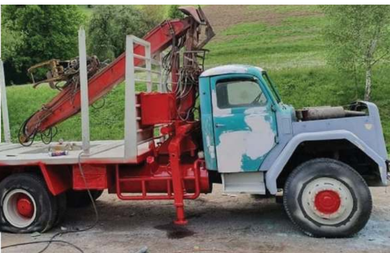
Medtem ko so šasijo že pobarvali, kabine niso še niti pokitali – zaradi pomanjkanja časa, je vzporedno teklo po več opravil.
