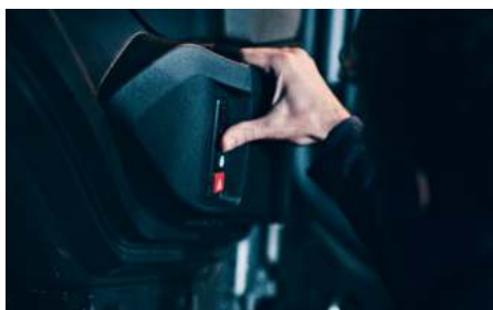
Nadzorna plošča MAN EasyControl s štirimi gumbi je nameščena v vratih. Pomembne funkcije vozila se lahko tako upravljajo tudi z zunanosti vozila.
