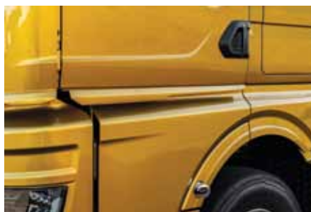
Difuzor in oblika vrat zmanjšujeta škropljenje umazanije na kljuko.
