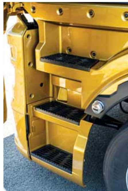
Dve stopnici sta sedaj nameščeni na šasiji vozila.
