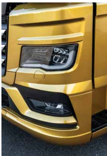
Žarometi z integriranimi dnevnimi lučmi in smernimi utripalkami poudarjajo novo zasnovano.
