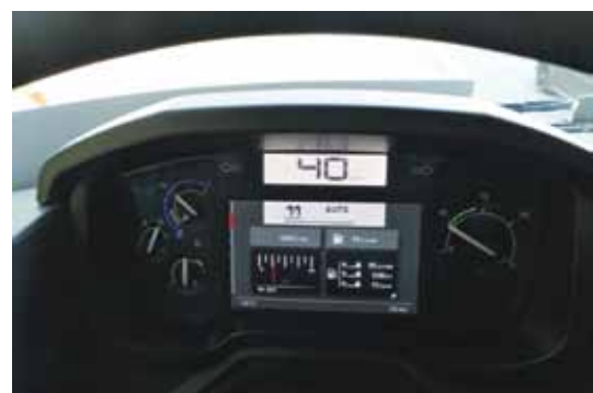
Zaradi »kratkih« pogonskih osi avtomatika pri hitrosti 40 km/h vozi že v 11. prestavi.
