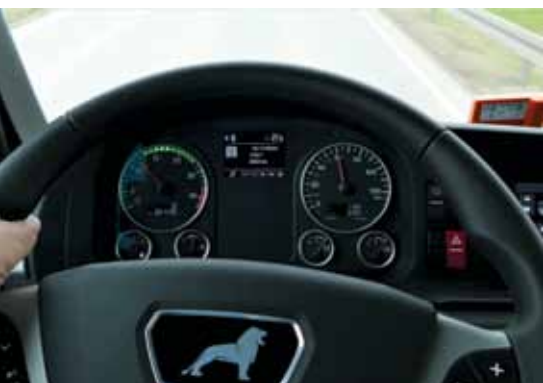
Motorji D 08 odlikuje široko območje največjega navora; najmočnejši štirivaljni pretakne iz direktne šeste prestave v peto šele pri 1.100 vrt./min (naloženo vozilo).
