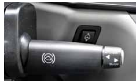
Z desno obvolansko ročico tako v TGE-ju kot TGM-u upravljamo enostopenjsko motorno zavoro in ročno pretikamo.
