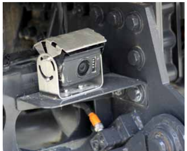
Pokrov zadnje kamere se odpre le, kadar je ta v uporabi.
