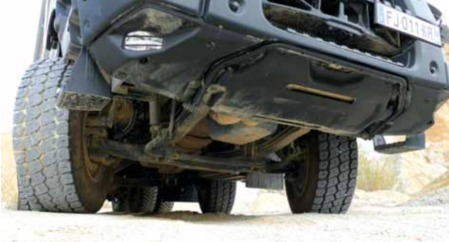
Sprednji osi podpirajo trilitne parabolične vzmeti.
