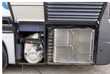
Motorni prostor je bil preoblikovan za večjo učinkovitost in boljše dostopnost, kar olajša opravljanje servisnih del in prinese prihrank 6 % pri popravilih in vzdrževanju.
