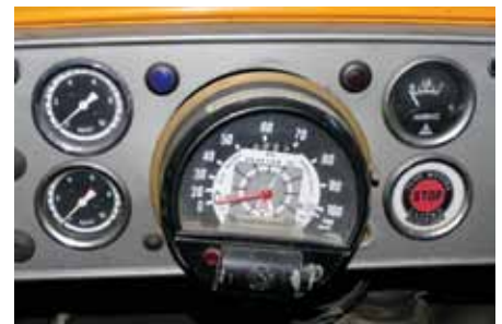
Kar zadeva instrumente – to je to: tlak olja in zraka, tahograf, merilec količine goriva ter opozorilo o pregretju motorja.
