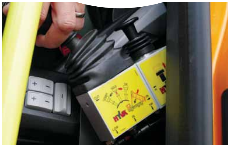
Večji vzvod je namenjen dviganju in spuščanju zaboja, manjši pa odpiranju ter zapiranju stranice
