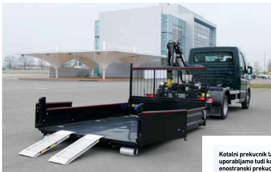
Zaboj je mogoče postaviti na tla in ga zamenjati z drugim.
