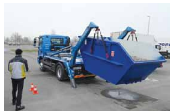
Hidravlični sistem voznik upravlja z brezžičnim upravljalcem.
