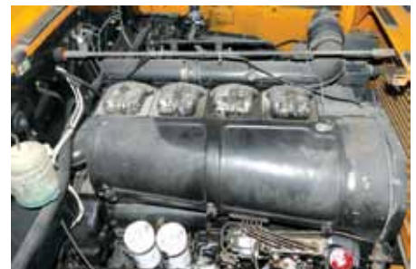
Štirivaljni zračno hlajeni dizel s 5,9 l gibne prostornine zmora 81 kW moči – ni hiter, je pa zato toliko bolj glasen.
