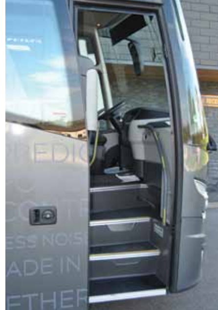
Sprednji vhod z ročaji olajša vstop starejšim.
