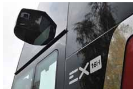
Nekateri modeli so imeli namesto vzratnih ogledal kamere, kot na primer EX16H.
