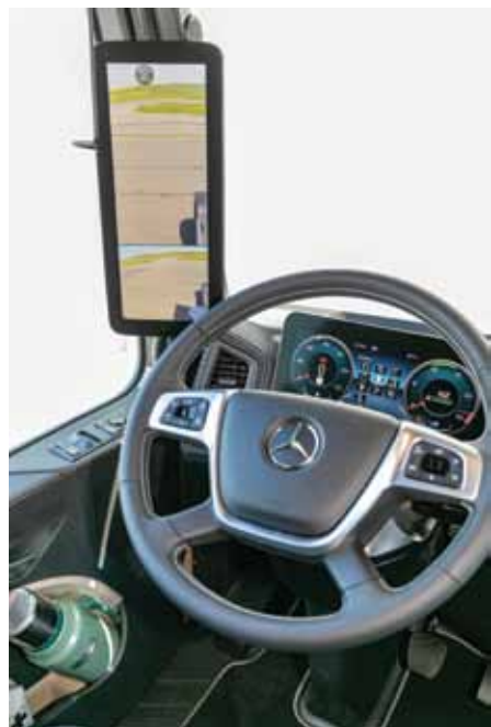
Mirrorcarn nudi dobro preglednost, vendar se na področju kontrastnega razmerja ne more primerjati z običajnimi vzvratnimi ogledali.
