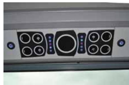
USB-priključki so slabo pozicionirani.
