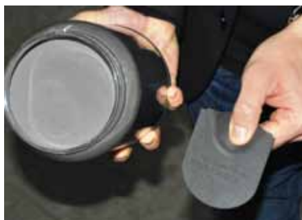
Iz „plastike“ je s tiskanjem nastal nov rezervni del.
