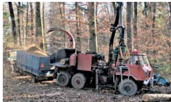
Tovornjak služi zgolj za prevoz, stroj za sekance ima lasten pogon.
