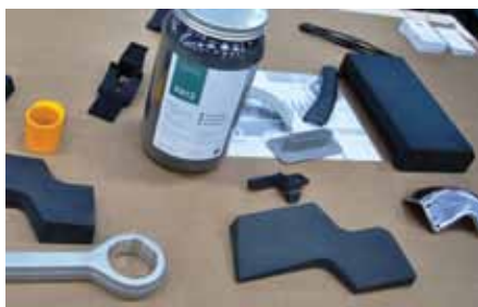
Primeri rezervnih delov za starejše avtobuse, ki so izdelani s 3D-tiskanjem.
