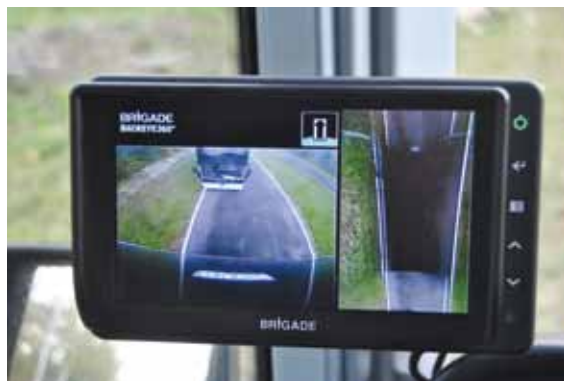
Sistem za nadzor nad dogajanjem zadaj – Brigade Backeye 360°.
