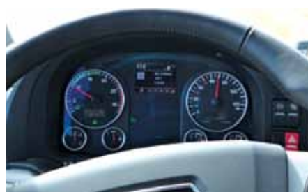
Pri hitrosti 69 km/h je menjalnik pri 900 vrt./min. še vedno v 14. prestavi.
