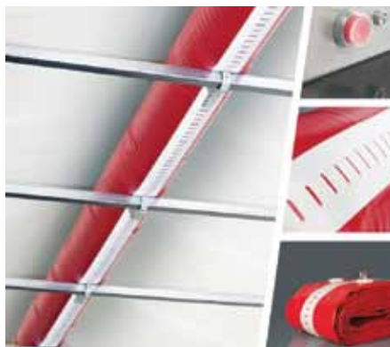
Strešna zračna blazina (RSAB) je certificiran in preizkušen sistem za preprečevanje zastajanja vode in ledenih plošč na prikolicah tovornjakov. Prikazan je primer vgradnje na prikolici Kögel. Sistem ponujajo tudi ostali proizvajalci prikolic.
