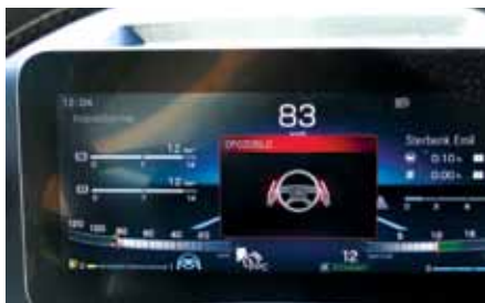
Po minuti se okvirček obarva rdeče, zvočni alarm pa se stopnjuje.
