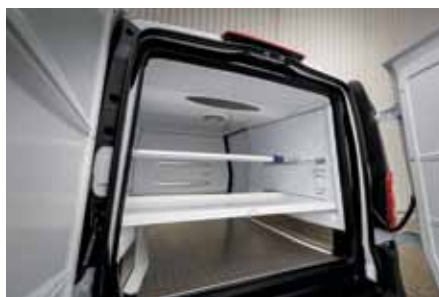
Posebnost modela eGrocery je v tem, da se njegov hladilni sistem napaja iz baterij za pogon vozila.
