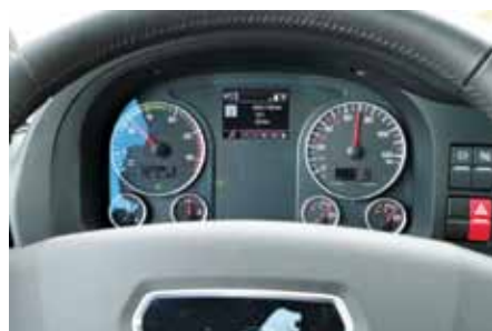
V 13. prestavi se motor pri 69 km/h vrti s 1.150 vrt./min. in pri tem odločno vleče.
