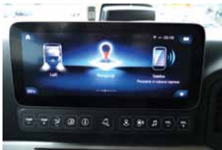
Novi Actros ponuja nepregledno množico različnih nastavitvev – elektronski možgani voznikove nastavitve »prikličejo« v spomin, ko ta v tahograf vstavi svojo kartico.
