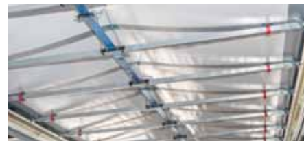
Sistem Krone Ice Protect Easy aktivira elektromotor; motor aktivira mehansko dvizhno napravo, ki je nameščena pod ponjavo na strehi prikolice, s čimer se prepreči zastajane vode na strehi prikolice.
